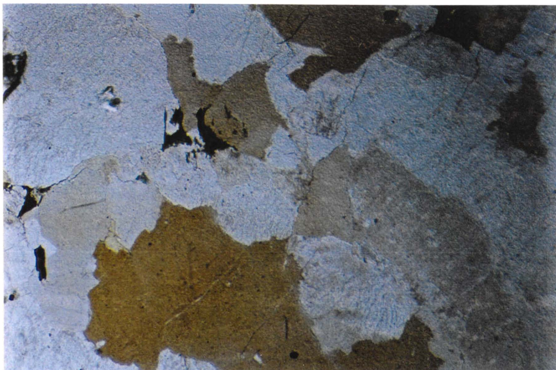
Fotomicrografia 4.3 - Padrão incipiente do microfissuramento da rocha bruta (nicóis descruzados, com filtro azul, zoom: 4 - lupa binocular).
