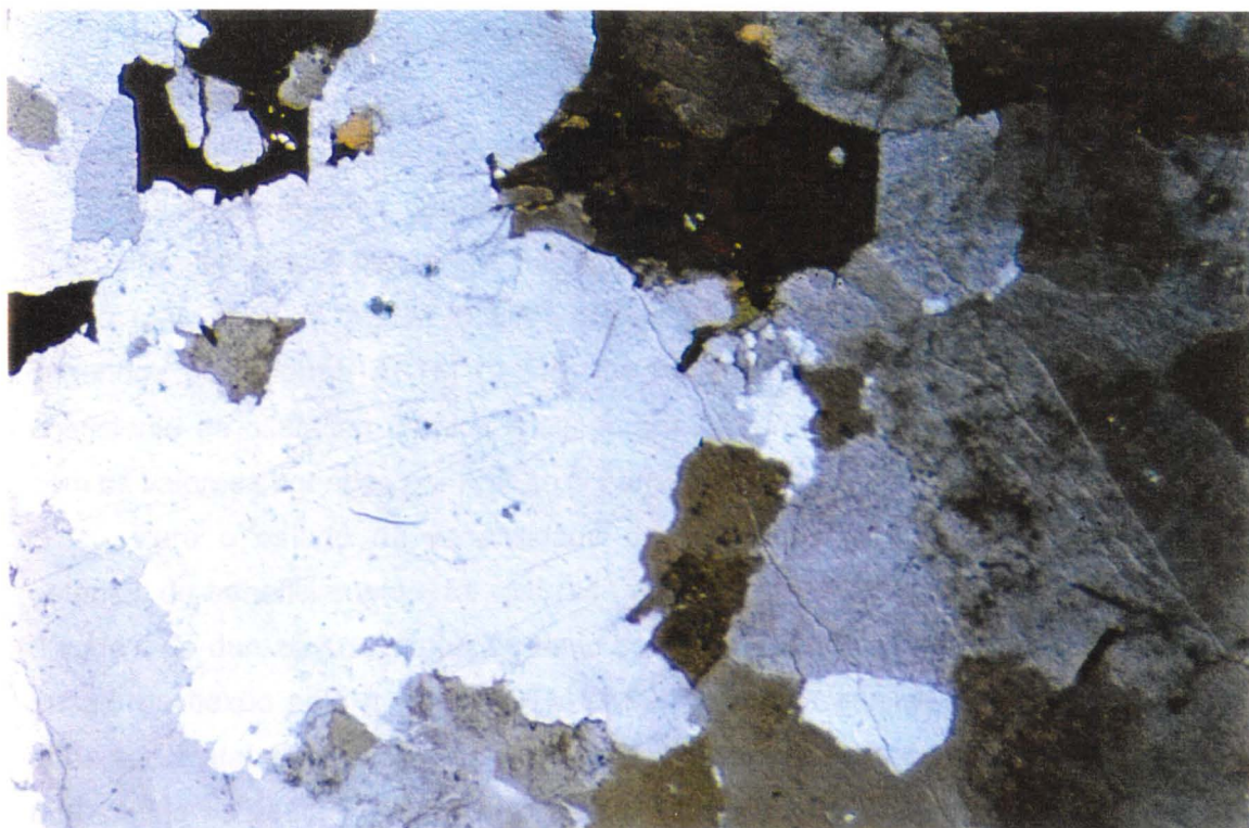
Fotomicrografia 4.5 - Padrão incipiente do microfissuramento da rocha bruta (nicóis descruzados, com filtro azul, zoom: 4 - lupa binocular).
