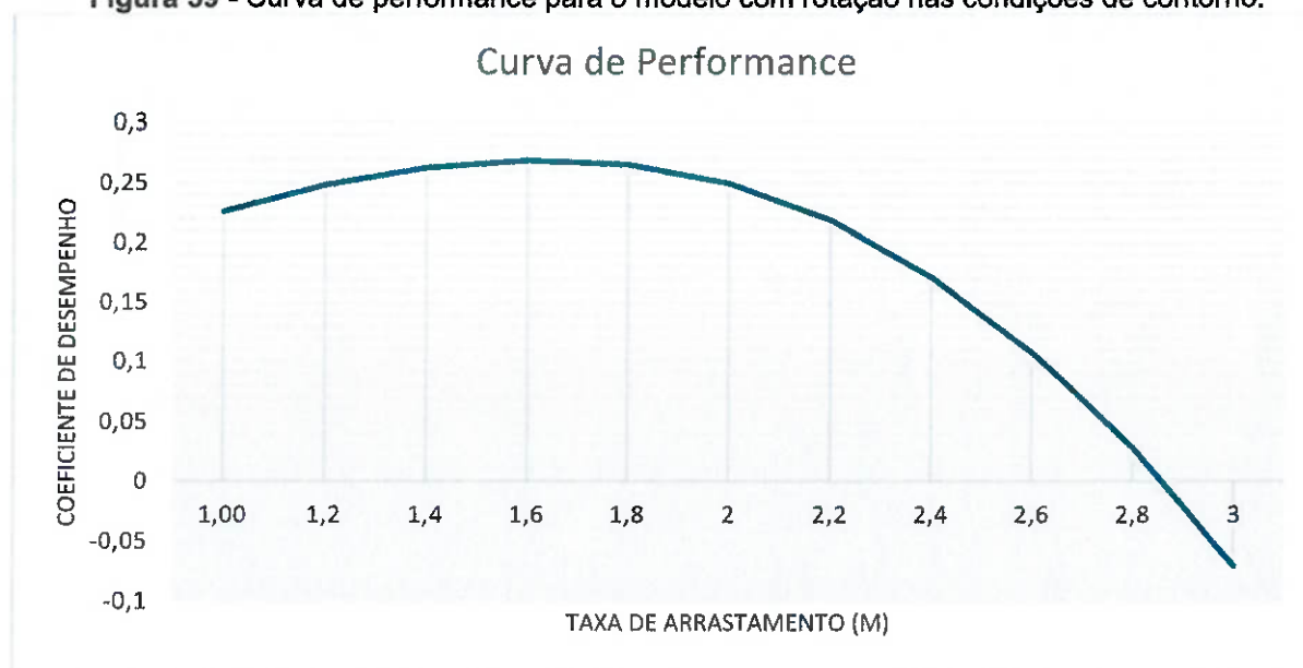
Figura 59 - Curva de performance para o modelo com rotação nas condições de contorno.
