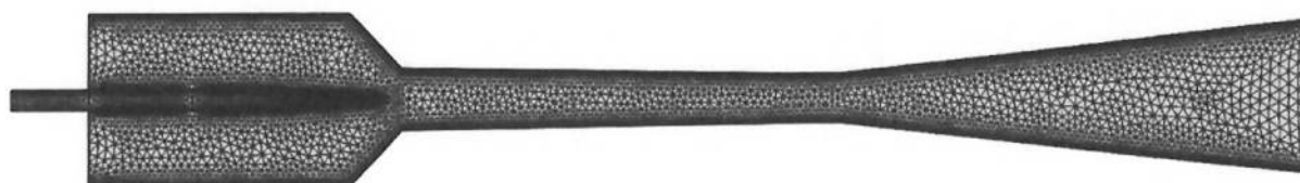
Figura 9 - Visão geral da malha - total de 9593 elementos.
