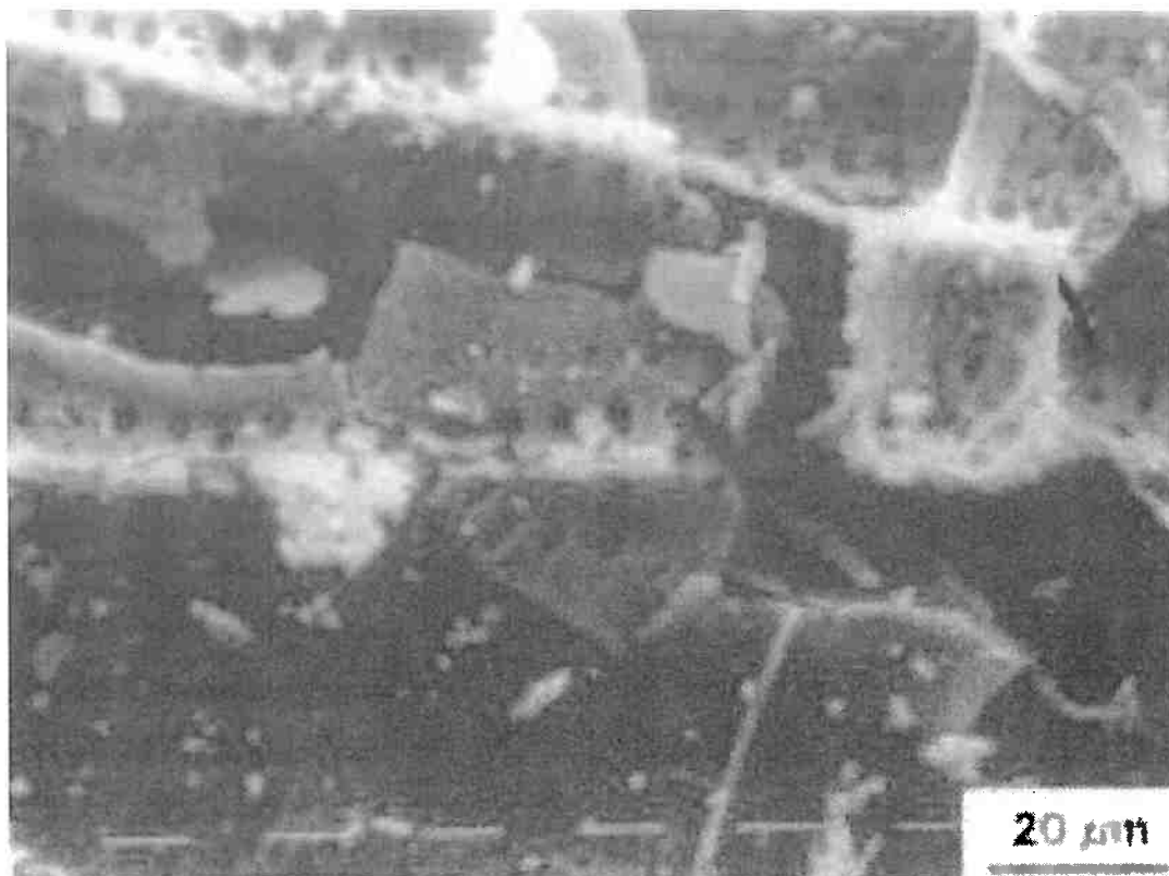
Figura 16. Microscopia eletrônica de varredura (MEV) por elétrons secundários mostrando a estrutura do carvão de eucalipto carbonizado com taxa de aquecimento de 30 °C por minuto e temperatura de carvoejamento de 1000 °C. Sem informação de aumento utilizado. Fonte: (KUMAR, VERMA, & GUPTA, 1999).
