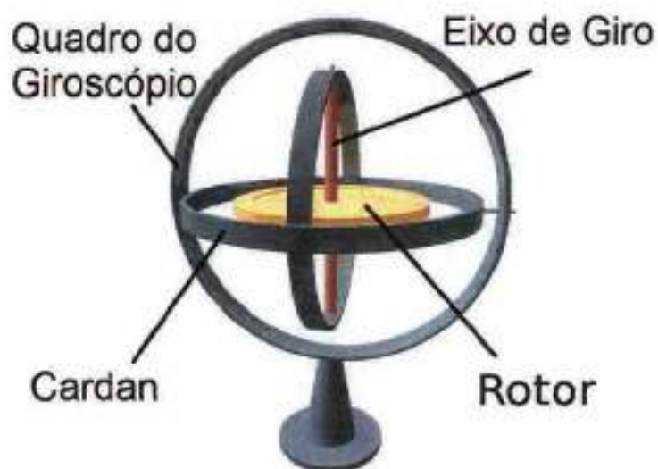
Figura 2.7 - Representação de um giroscópio mecânico.
