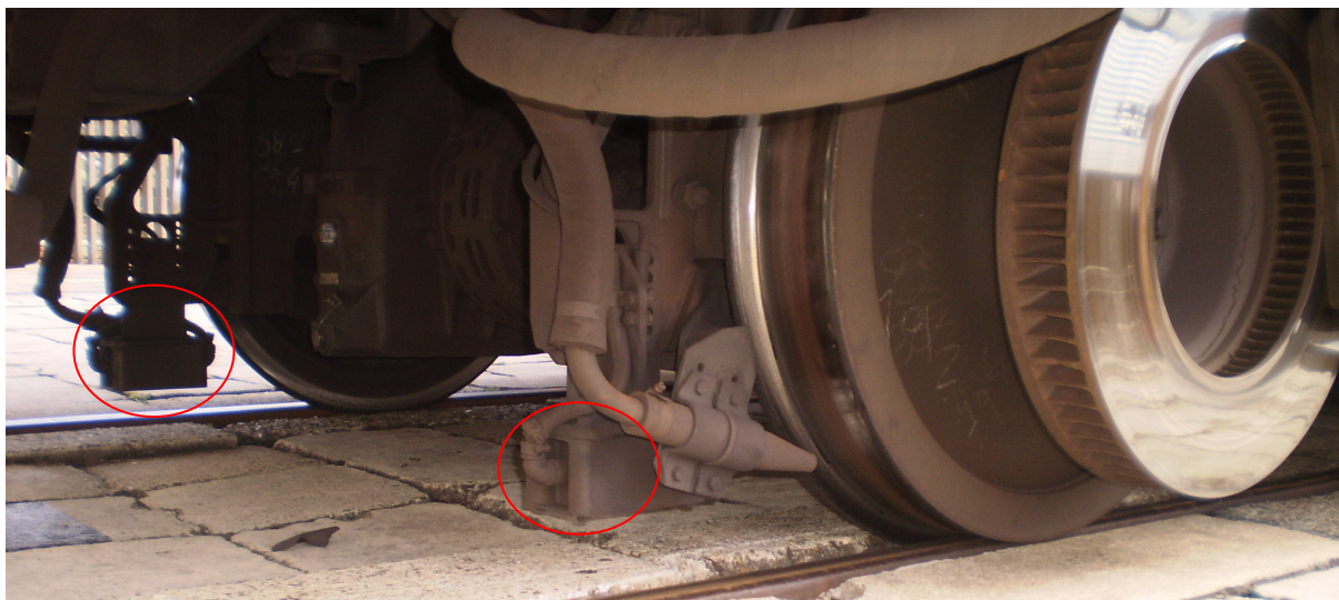
Foto 1 – Localização das antenas de sinal de via no trem
