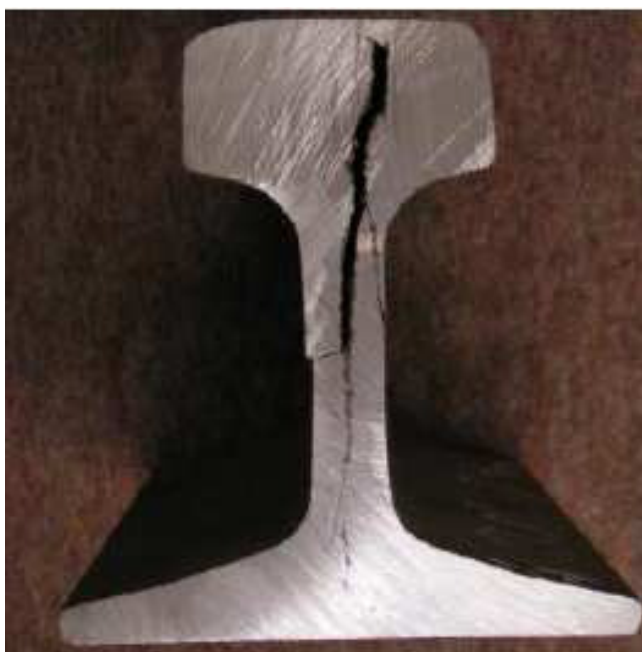
Figura 5 – Ilustração de fissura transversal no trilho de rolamento
