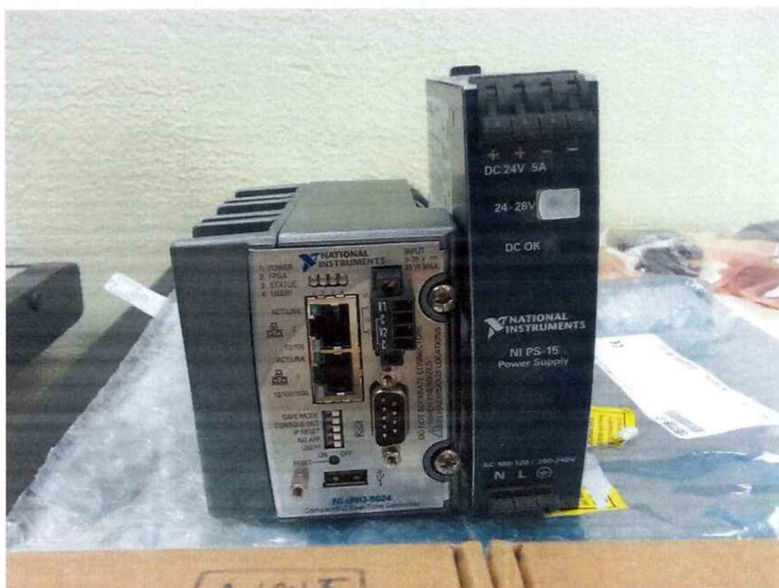
Figura 2 - Controlador NI cRIO-9024 e fonte
