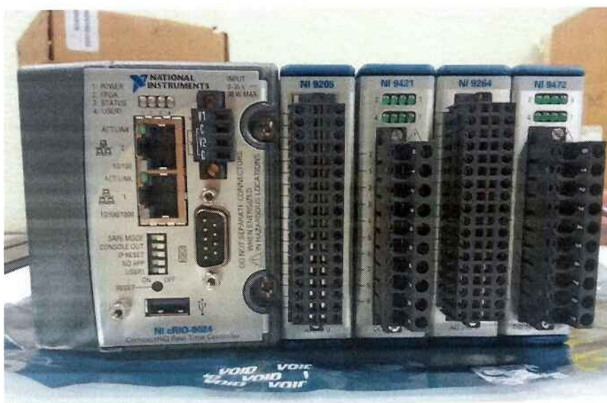
Figura 4 - Controlador com os cartões de entrada e saída
