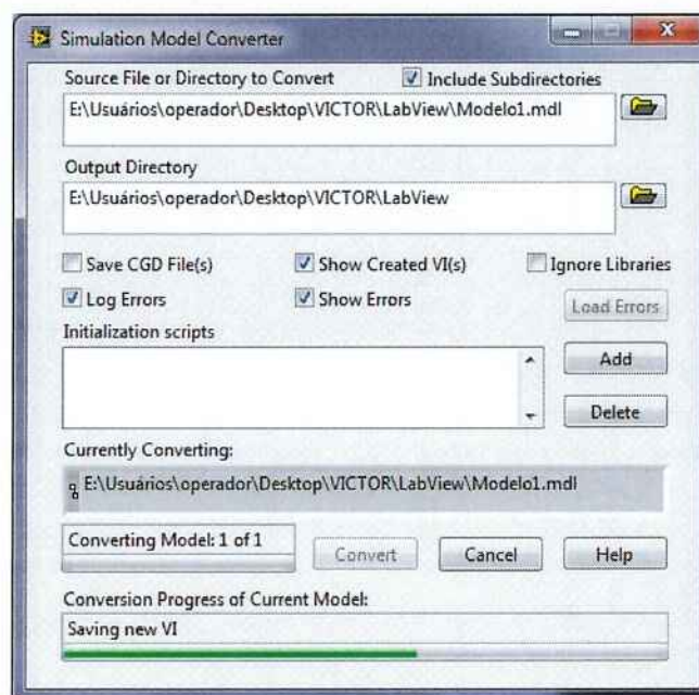
Figura 18 - Conversão do arquivo ".mdl" para o LabVIEW em progresso
