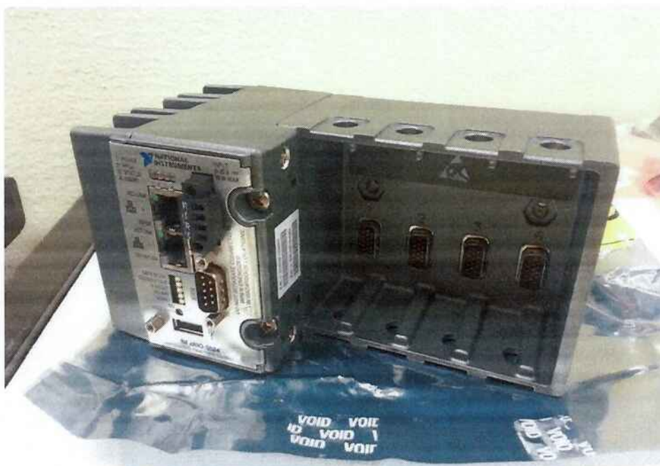
Figura 3 - Controlador NI cRIO com o módulo de encaixe dos cartões
