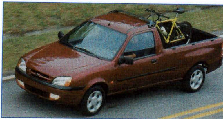
Figura 8: Os Ford Courier (ao lado) e Fiesta compartilham a mesma plataforma, mas a distância entre eixos da picape (2830 mm) é bem maior que a do hatch (2445 mm). Seus assoalhos traseiros, porém, são diferentes.
