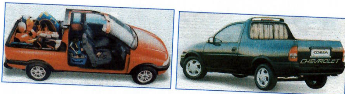
Figura 10: Sucesso de vendas, a Fiat Strada Cabine Estendida (acima, à esquerda) ganha em espaço interno mas perde na caçamba. Com a plataforma variável, a picape Chevrolet Corsa (acima, à direita) ganharia o espaço interno da Strada, mas mantendo a capacidade da caçamba.
