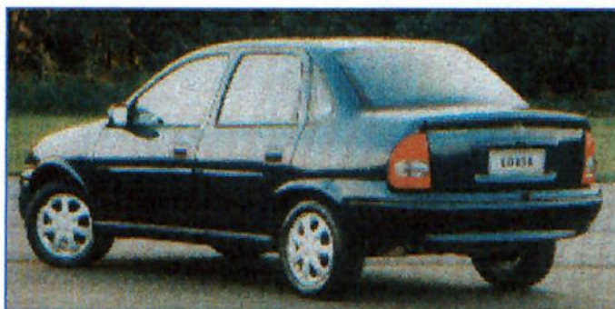
Figura 4: Chevrolet Corsa, à esquerda, tem plataforma integrada à carroceria, no conceito monobloco, como a grande maioria dos atuais carros de passeio
