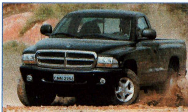
Figura 3: A Dodge Dakota, à direita, é um modelo utilitário de grande porte que ainda utiliza a construção tradicional, com "chassi" separado da carroceria.
