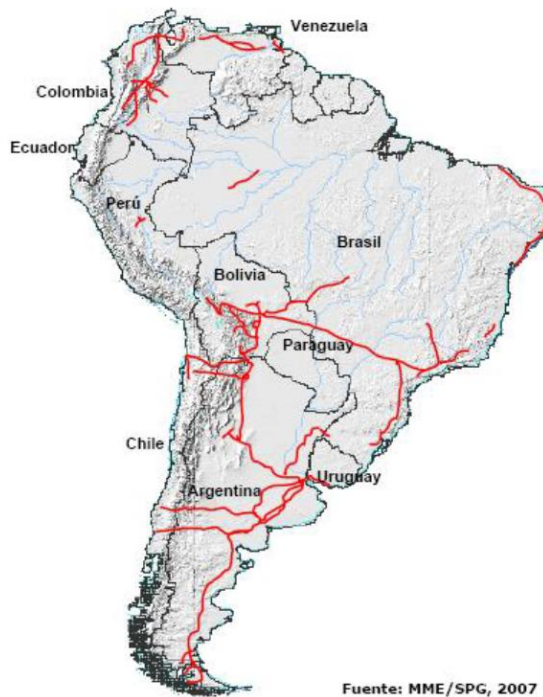
Figura 19: Mapa de Gasodutos existentes na América do Sul, uma amostra da pouca conexão entre o Cone Sul e a Região Andina mais ao norte. Divergências entre os países e obstáculos naturais são os maiores empecilhos na integração energética. Fonte: EPPGG
