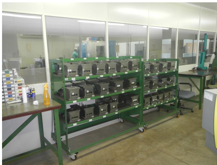
Figura 7: Matrizes usadas para a injeção dos padrões de plástico (foto do acervo pessoal do autor).
