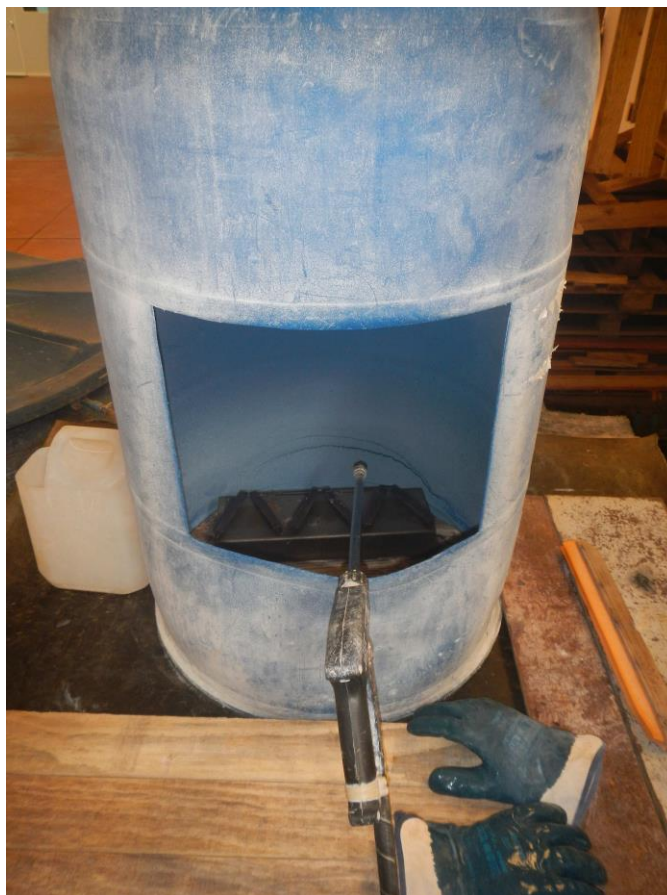
Figura 12: Jateamento com água e alta pressão (foto do acervo pessoal do autor).
