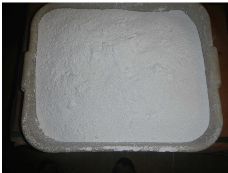
Figura 10: Revestimento utilizado. O pó é misturado com água em uma proporção predeterminada de acordo com as instruções do fabricante (foto do acervo pessoal do autor).
