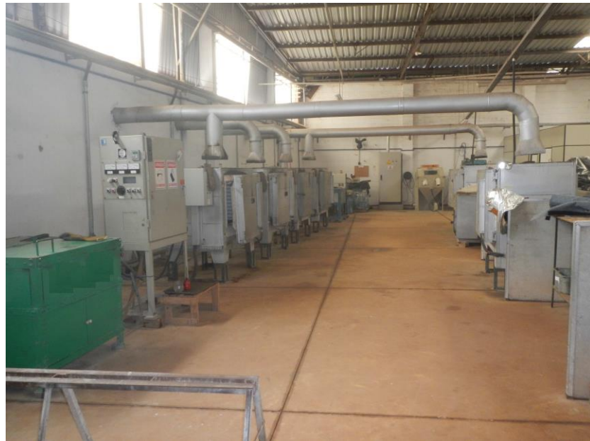
Figura 11: Fornos de queima da cera e plástico e a máquina de fundição por indução centrífuga (verde) (foto do acervo pessoal do autor).
