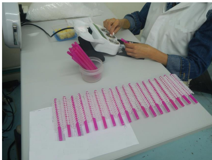
Figura 8: Montagem das árvores de fundição, composta de peça plástica mais haste de cera juntamente com a referida ordem de produção (foto do acervo pessoal do autor).
