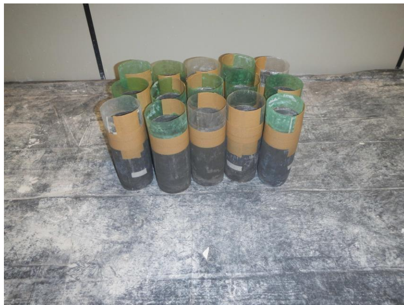
Figura 9: Cilindros de fundição onde as árvores de fundição são colocadas, ficando em descanso dentro do revestimento decantando em 2 a 3 dias (foto do acervo pessoal do autor).
