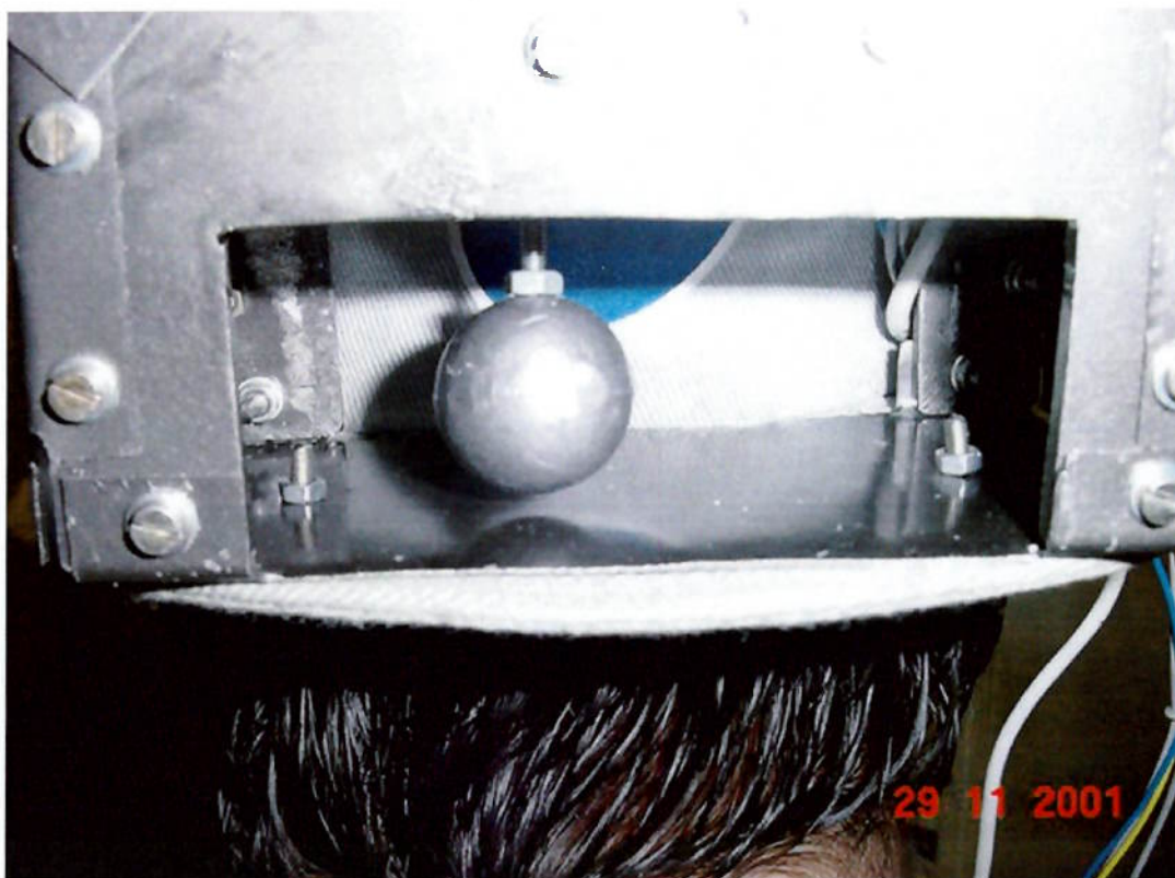
Foto 28 – Detalhe do pêndulo do mouse de cabeça
