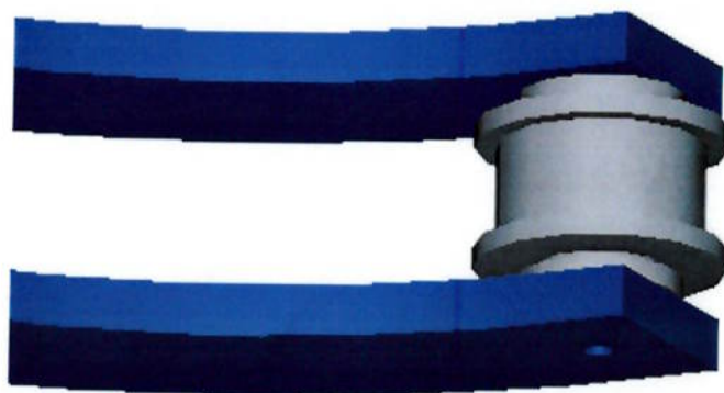
Figura 17 - Separação final dos trilhos, com polia para o cabo
