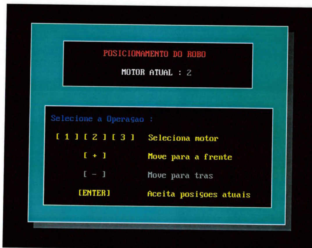
Figura 56 – Exemplo de tela – Configuração dos parâmetros do robô
