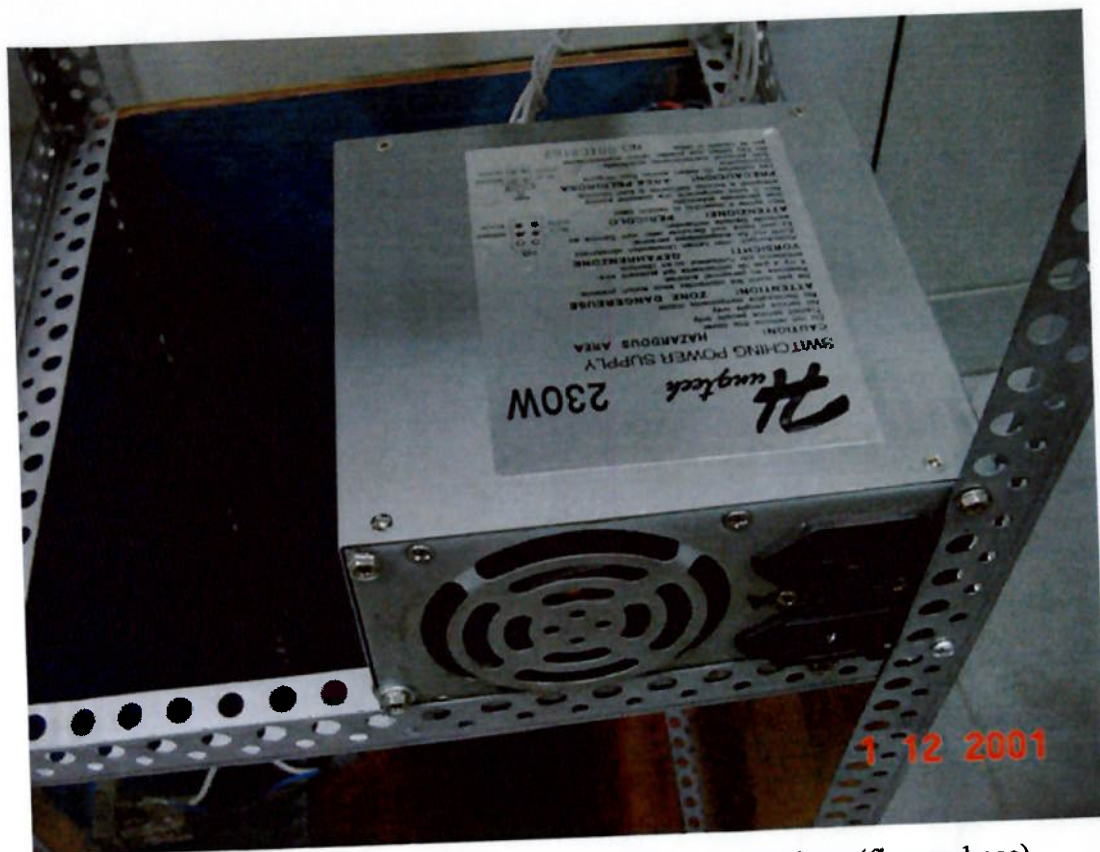
Foto 29 – Fonte utilizada para suprir os sistemas elétricos (fixa na base)
