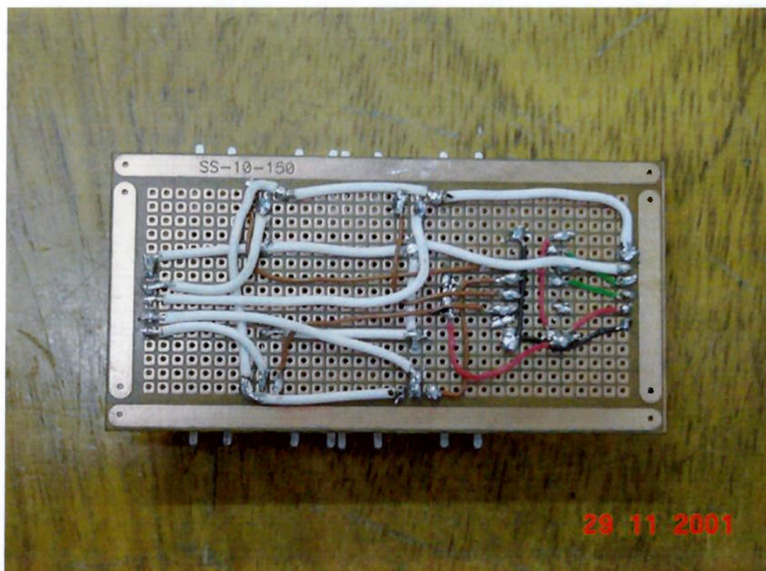
Foto 16 – Vista inferior de um driver de motor de passo
