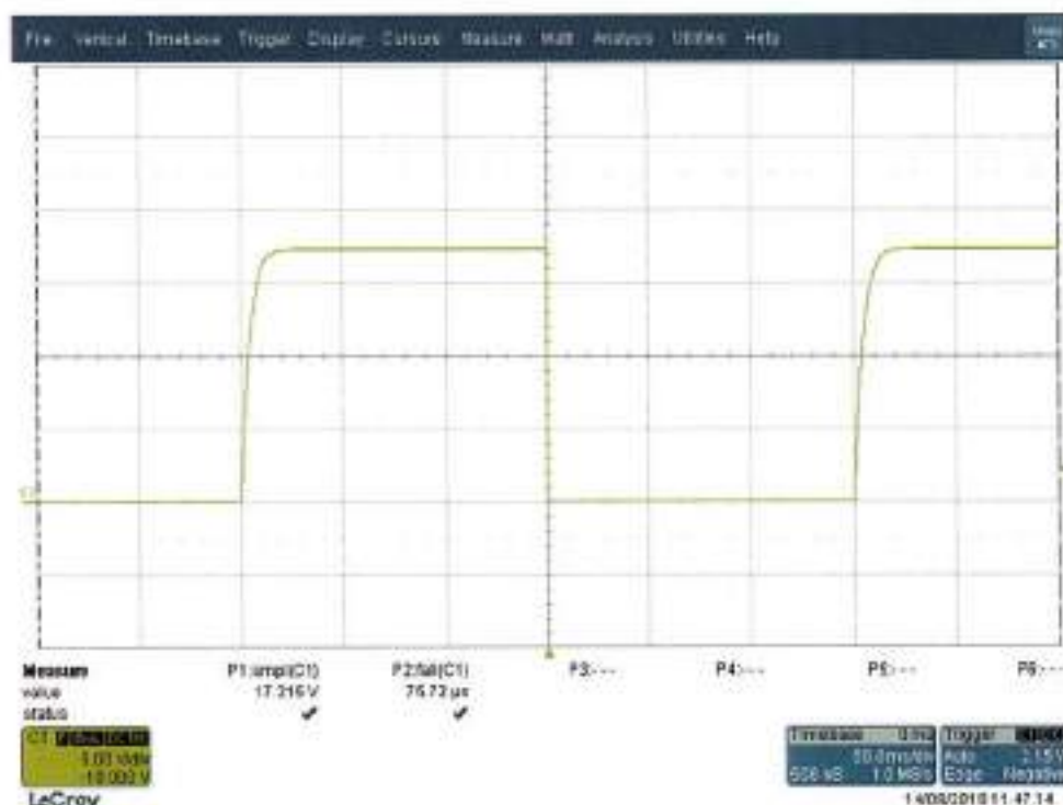
Figura 23: Forma de onda da queda de tensão no conjunto de capacitores
