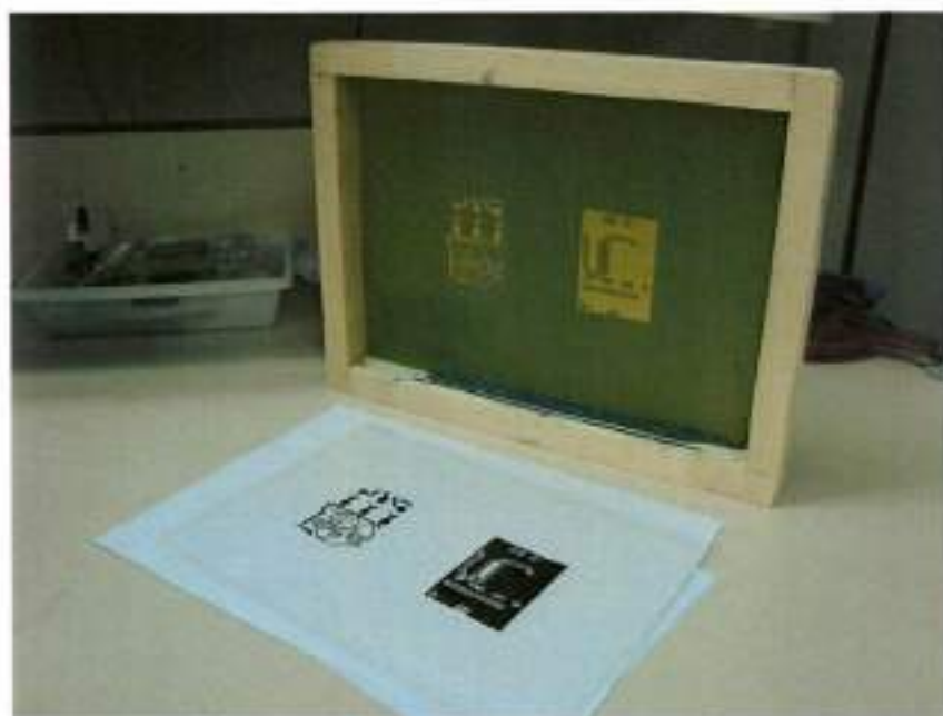
Figura 36: Fotolito e tela utilizados no processo de serigrafia.
