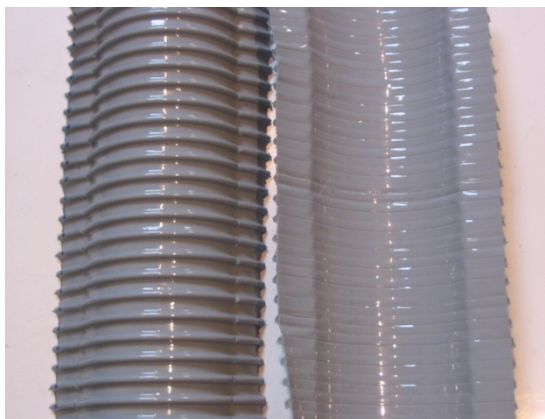
Figura 75 - Dreno pré-fabricado, em forma de meia cana: corrugado por fora, liso por dentro, minimizando a formação de depósitos e entupimentos
