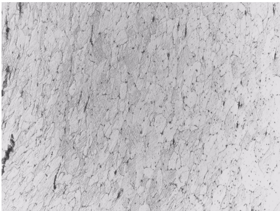
Figura 28: Amostra 134 após ataque com nital 2%, com zoom de 50x
