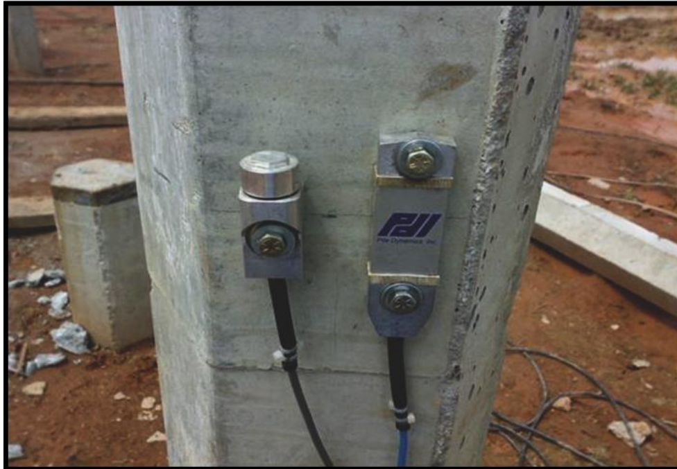
Figura 47: Transdutor de deformação específica e acelerômetro distantes de 2xD da cabeça da estaca
