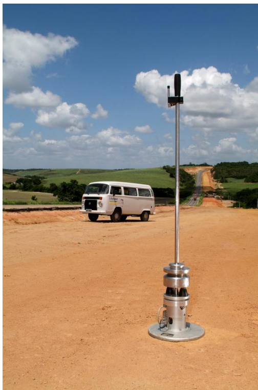
Figura 203 - Visão Geral LWD - Fonte: Dynatest
