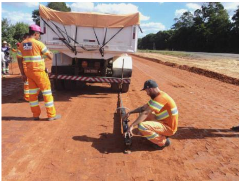
Figura 201 - Ensaio Viga Benkelman em campo - Fonte: Dynatest
