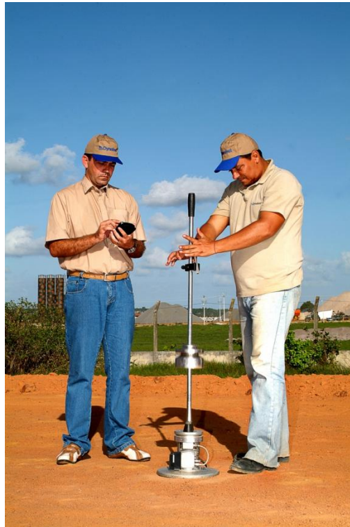
Figura 204 - Ensaio LWD em campo - Fonte: Dynatest
