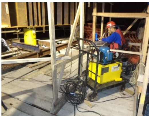
Figura 28: Prova de carga estática do píer, estaca EPC01
