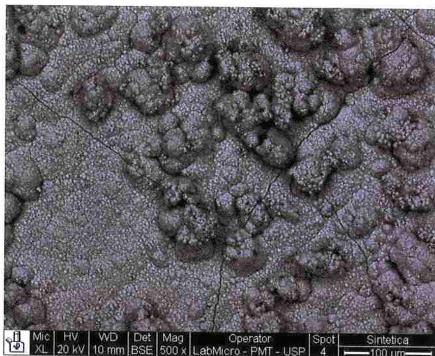
Figura 32 – Imagem de elétrons retro-espalhados da superfície do anodo contendo material eletrodepositado a partir da solução sintética. Aumento de 500X
