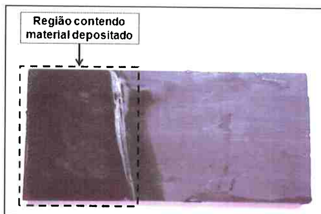
Figura 30 – Anodo após eletrodeposição realizada com solução sintética
