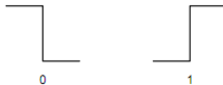
Figura 8: Nível lógico alto e baixo da codificação Manchester. Fonte [23]
