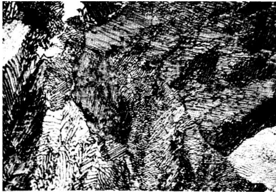
Figura 4: Micrografia de um aço eutetóide esfriado lentamente
