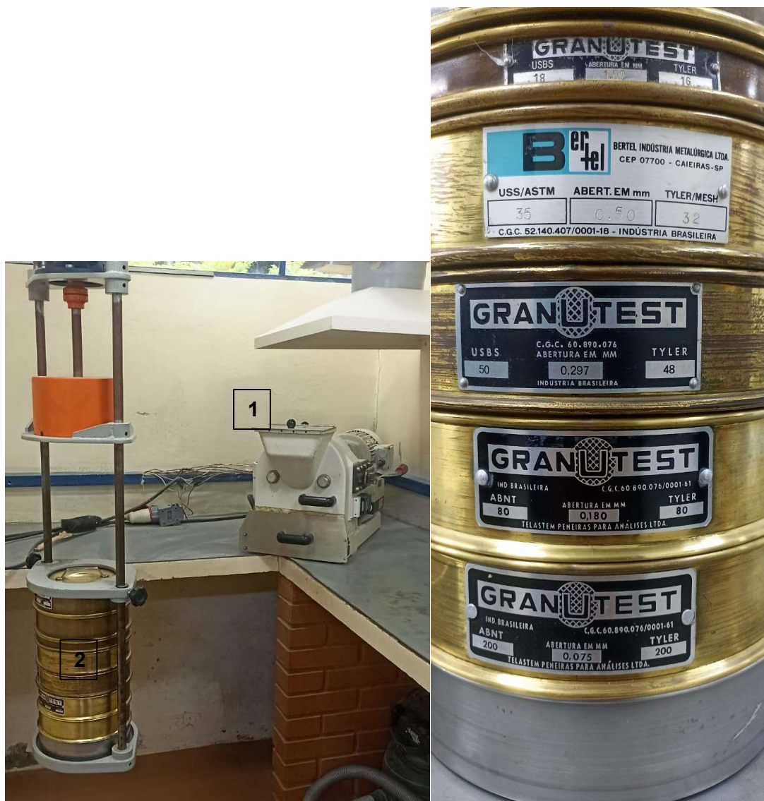
Figura 02- Esquerda: 1) moinho de disco e 2) agitador mecânico. Direita: Esquema de painéis com as frações passantes.
