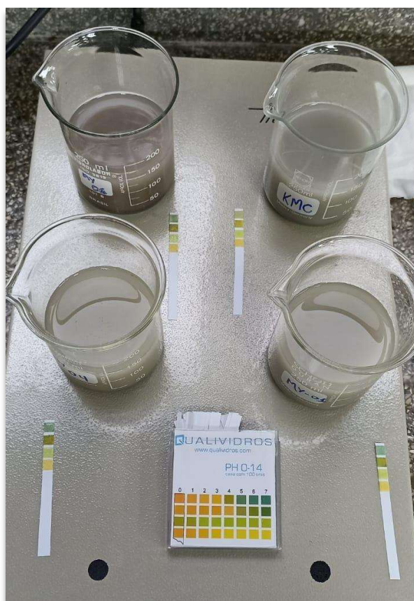
Figura 07 – Disposição dos beckers sobre o agitador magnético. Notar pH próximo de 5.
