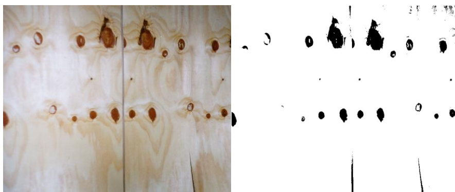
Figura 6 - Utilização de algoritmos de visão computacional para inspeção de qualidade na indústria madeireira. (SEMINÁRIO INTRODUÇÃO À VISÃO COMPUTACIONAL, 2014).
