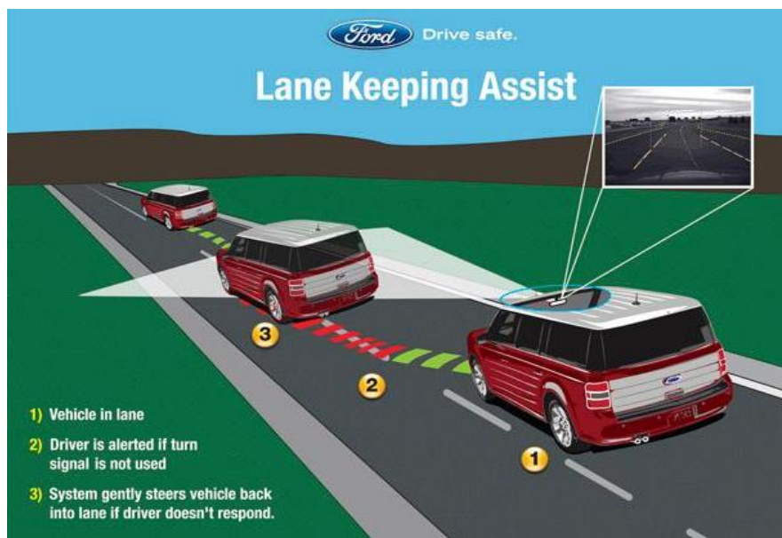
Figura 1 -Ilustração explicativa sobre o sistema Lane Keeping Assist do fabricante Ford. Disponível em: < http://www.beachautomotive.com/blog/wp-content/uploads/2014/07/Blog-1-pic-1-Beach-Auto-Top-safety-checks.jpg > Acesso: 2 de nov. 2014.
