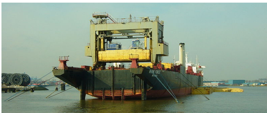
Figura 18. Navio RHINE FOREST , exemplo de navio porta-barcaça.
