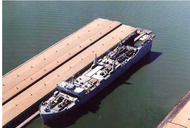
Figura 19. Navio SS CAPE MOHICAN, exemplo de navio SEABEE.
