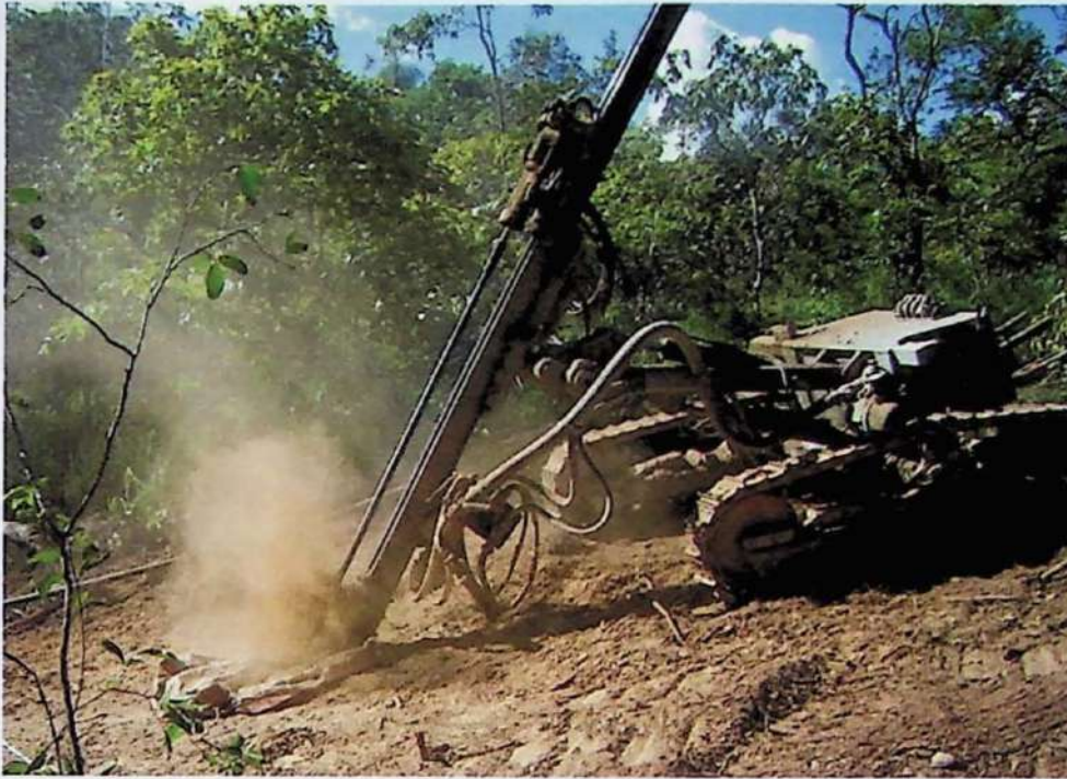
Figura 7: Perfuratriz utilizada nas investigações do minério de ferro.
