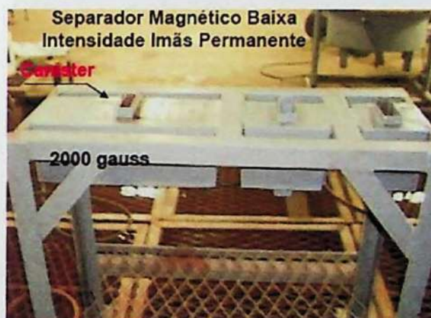
Foto 4 – Separador magnético de baixa intensidade (2000 gauss).
