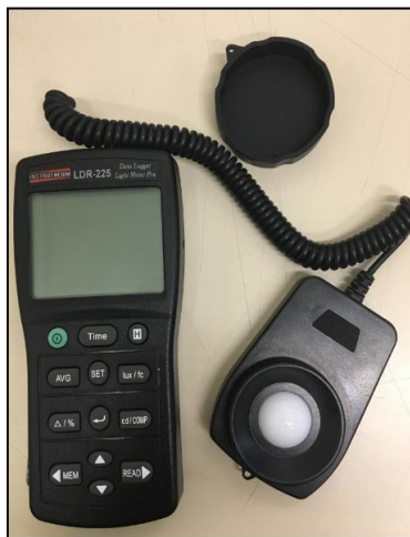
Figura 4 – Exemplo Luxímetro com célula desacoplada
