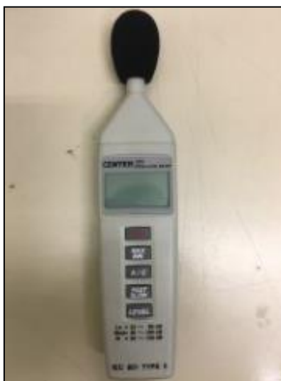
Figura 3 – Exemplo de medidor de nível de pressão sonora CENTER 325 (decibelímetro)
