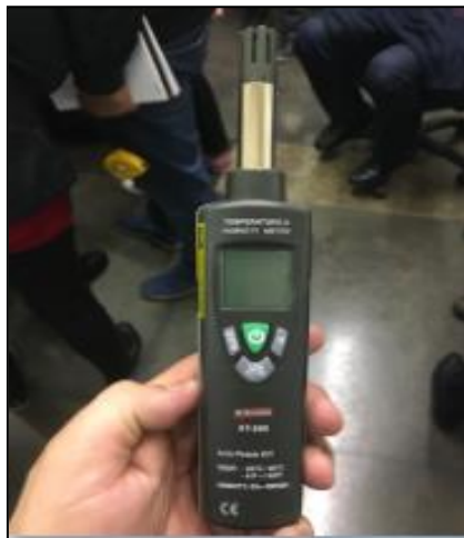
Figura 6 – Exemplo de Termo-higrômetro digital INSTRUTHERM HT - 260
