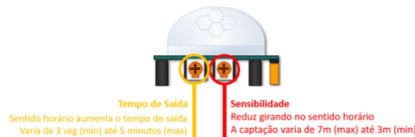
Figura 5 – Ajustes de operação do PIR
