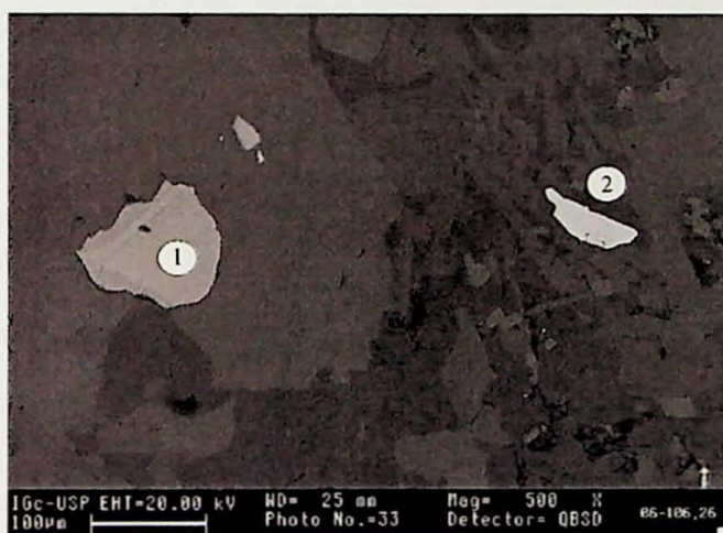
06-106,26-106,80. À esq., pirita (1) e molibdenita (2). Aumento de 500x; à dir., seção 01-66,30 – magnetita (1) e telureto de Pb (2). Aumento de 350x.
