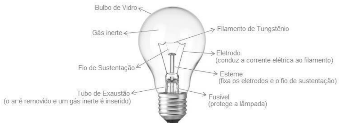
Figura 5.2 – Componentes da Lâmpada Incandescente:
