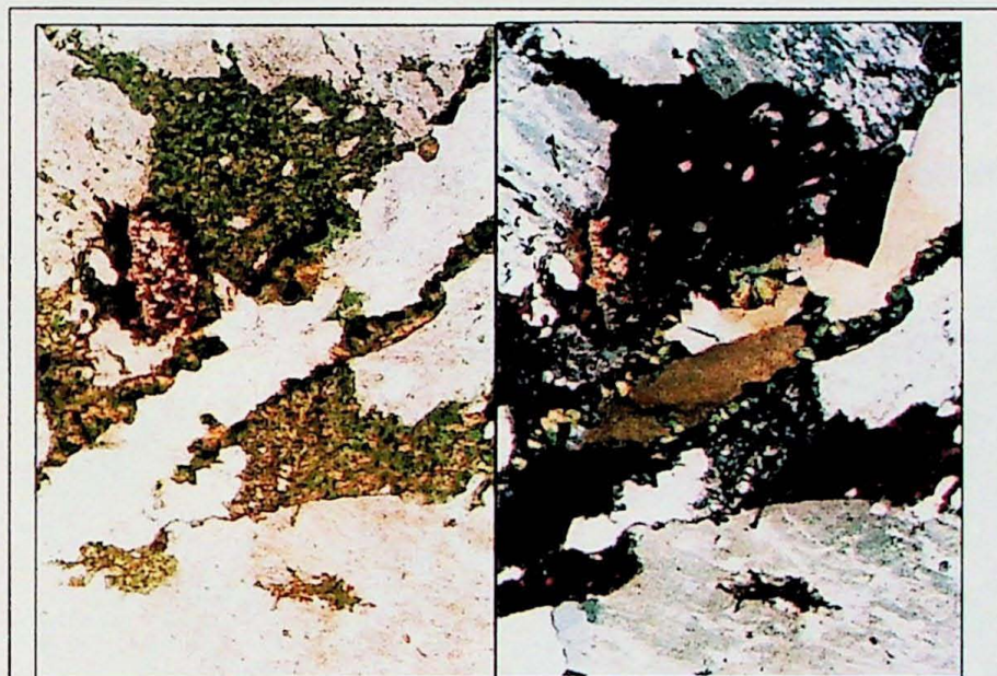
FOTO 17 - Fratura preenchido por quartzo e clorita, onde a alteração propílica grada do estilo fissural para o pervasivo. Amostra FBT-3/2. Lado menor da foto 3,5mm. Analisador cruzado na foto a direita.
