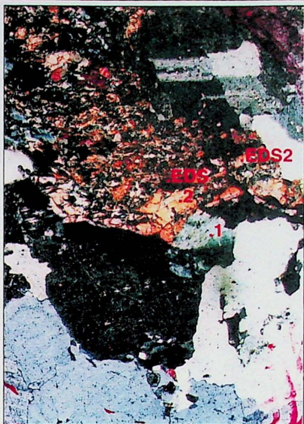
FOTO 41 - O ponto 1 corresponde a análise na clorita e o ponto 2 análise no epidoto. Amostra FBT-2/5. Também estão indicados na foto os pontos de análise de EDS. Lado menor da foto 3,5 mm.
