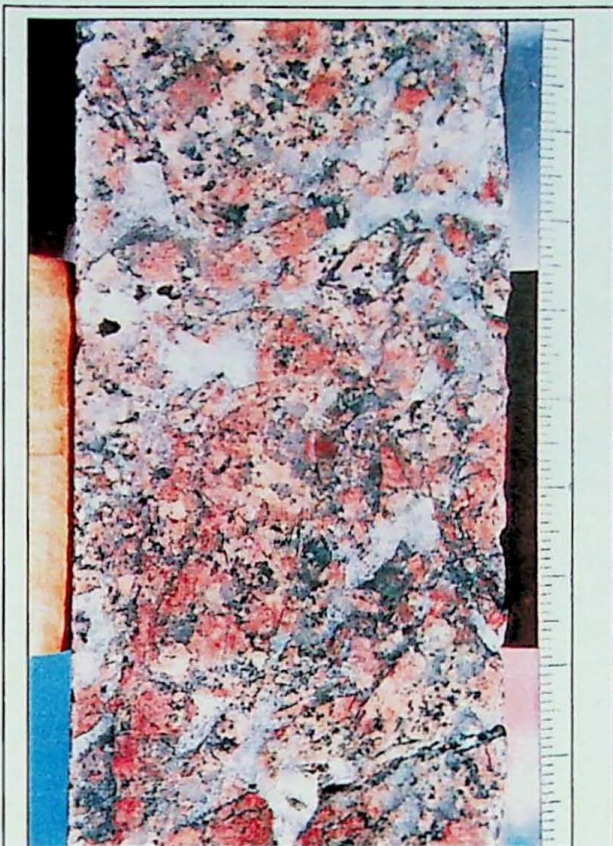
FOTO 10- Granito brechado cimentado por calcita e fluorita. Amostra FBT-2/9
