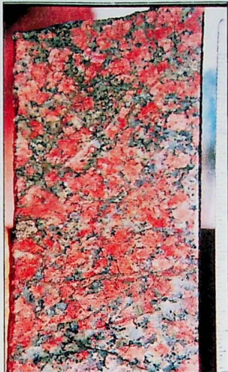
FOTO 20- Granito cortado por microfraturas e com alteração hidrotermal potássica. Observa-se ainda a biotitização ao redor do microclínio. Amostra FBT-4/7.
