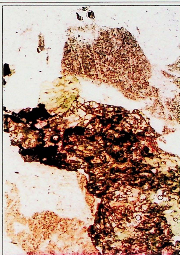
FOTO 13 - clorita e epidoto produto de alteração hidrotermal do tipo propílica. Amostra FBT-2-5. Lado menor da foto 3,5mm. Analisador cruzado.
