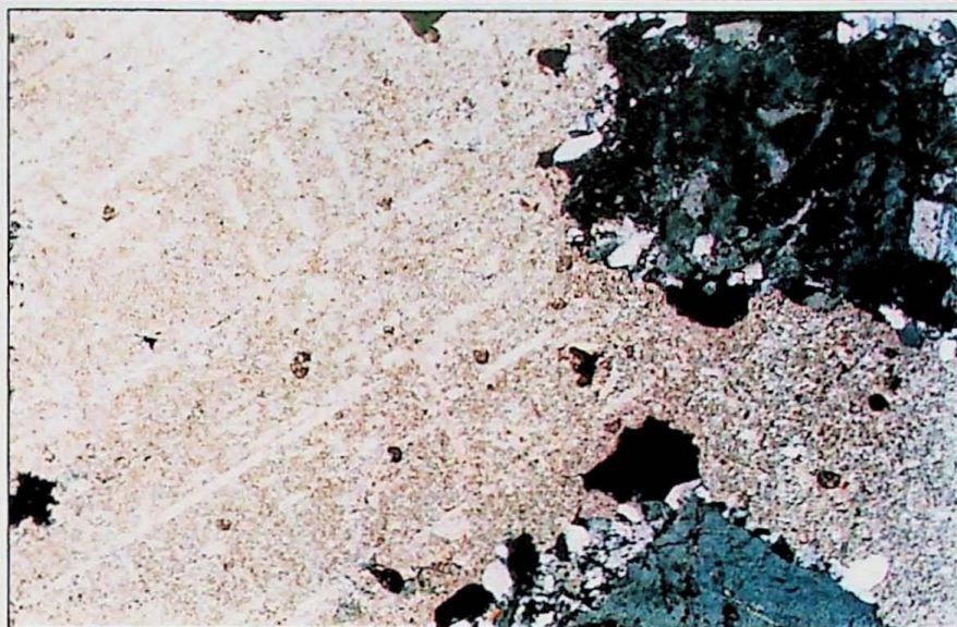
FOTO 31 - Veio de carbonatos com clastos de quartzo, feldspato nas bordas, produto de alteração propílica fissural associada a zonas de brechação. Amostra FBT-2/9. Lado menor da foto 3,5mm. Analisador cruzado.
