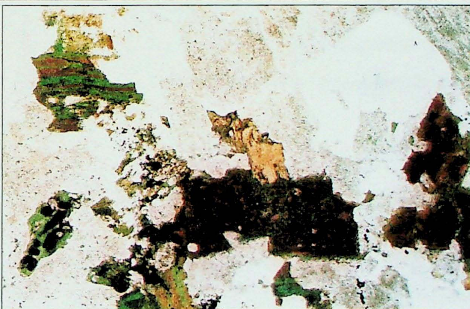
FOTO 23 - Biotita ígnea de coloração avermelhada, substituída por biotita de origem hidrotermal, de coloração esverdeada. Associada-se a biotita epidoto e opacos. Amostra FBT-4/2. Lado menor da foto 3 5mm
