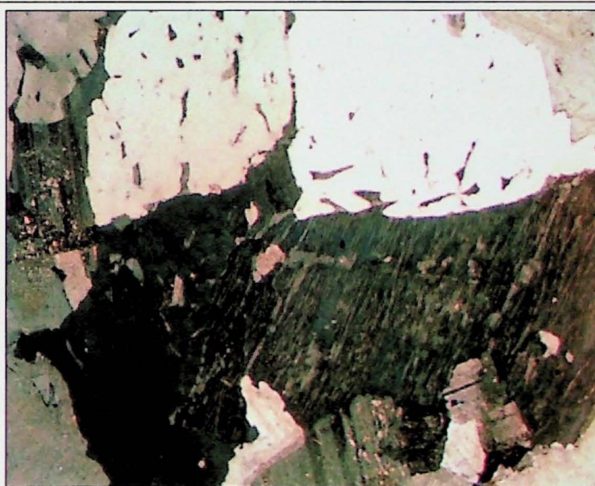
FOTO 3- textura granofírica gerada pelo intercrescimento de quartzo e feldspato potássico pertítico. Amostra FBT-1-6. Lado menor da foto 3,5mm. Analisador cruzado.
