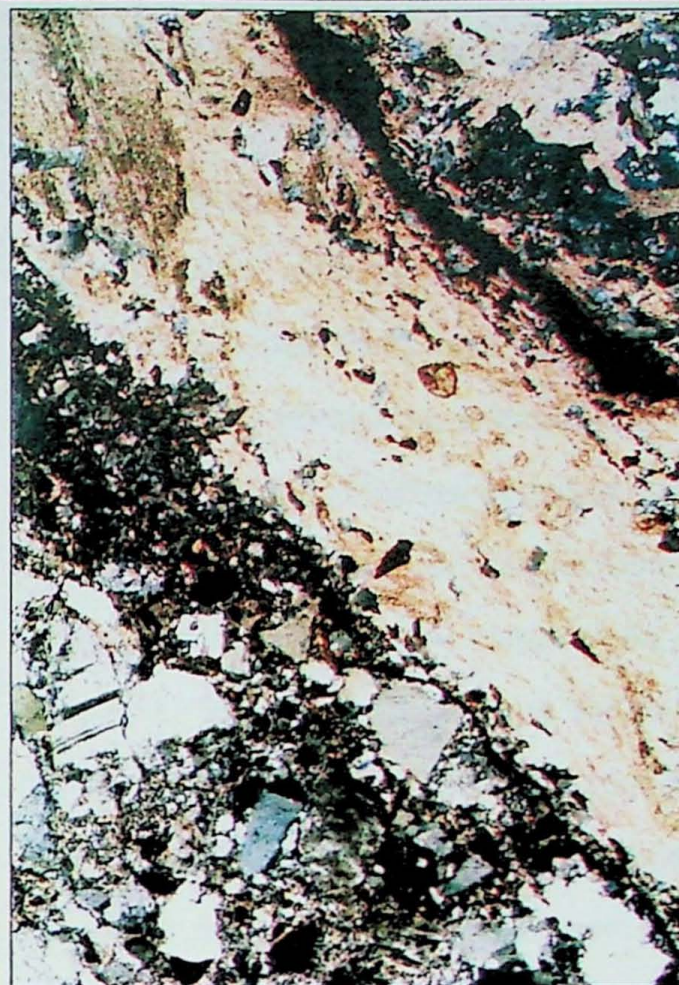
FOTO 14 - veio cataclástico preenchido por carbonato. Clastos de quartzo e feldspato. Alteração propílica fissural. Amostra FBT-2-1. Lado menor da foto 3,5mm. Analisador cruzado.
