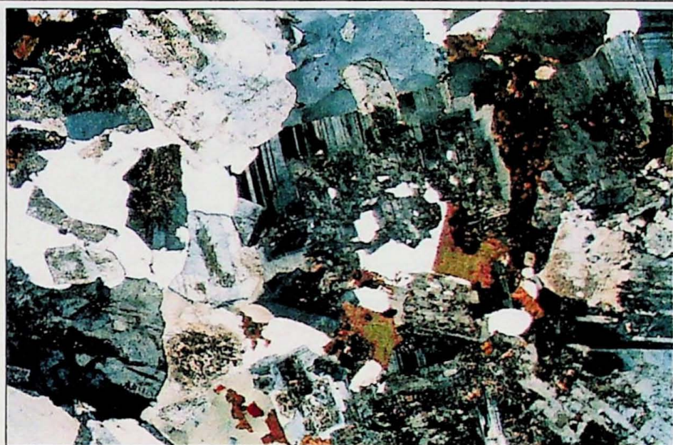
FOTO 30 - Microclínio pertítico com borda de albita, microclinizado intercrescido com quartzo, produto do metasomatismo alcalino. Observa-se também biotita hidrotermal. Amostra FBT-1/5. Lado menor da foto 3,5mm. Analisador cruzado.
