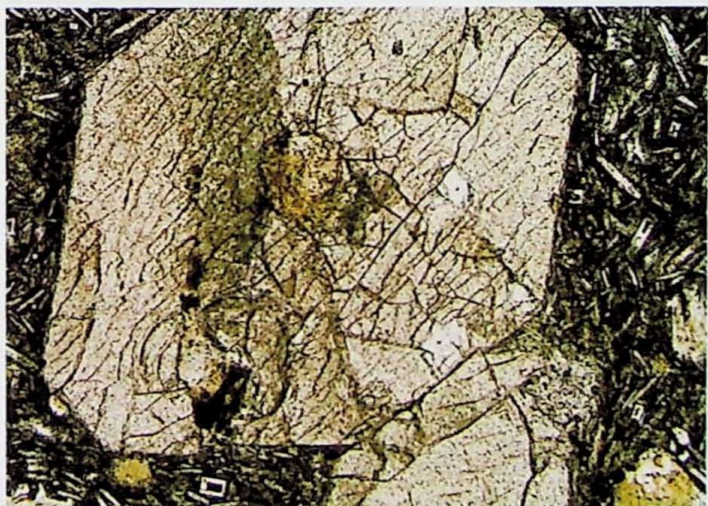
Fig. A5.5 - Fotomicrografia da amostra W-04 (derrame 4). Detalhe de fenocristais de piroxênio (Augita). Nicóis cruzados. Objetiva: 10X.
