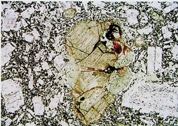
Fig. A5.15 - Fotomicrografia da amostra W-12B (derrame 3). Detalhe de cristal de olivina substituído por argilo-minerais de cor esverdeada (esmectita?) e fraturas alteradas para minerais de cor laranja-avermelhada (iddingsita?). Nicóis paralelos. Objetiva: 4X.
