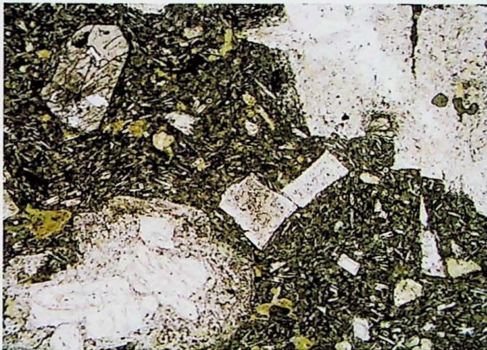
Fig. A5.9 - Fotomicrografia da amostra W-04 (derrame 4). Fenocristais de plagioclásio (Andesina) e clinopiroxênio (Augita - no canto superior esquerdo da foto). Notar estruturas de fluxo magmático na matriz da rocha. Nicóis paralelos. Objetiva: 4X.
