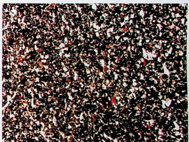
Fig. A5.22 - Fotomicrografia da amostra W-02 (Regolito (sedimento?) estratificado - derrame 6). Detalhe da porção mais fina da rocha. Nicóis paralelos. Objetiva: 4X.
