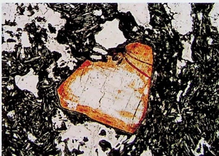
Fig. A5.17 - Fotomicrografia da amostra W-19C (sucessão regolítica do derrame 7). Detalhe de cristal de piroxênio/olivina (?) parcialmente substituído por óxido de ferro. Nicóis paralelos. Objetiva: 10X.
