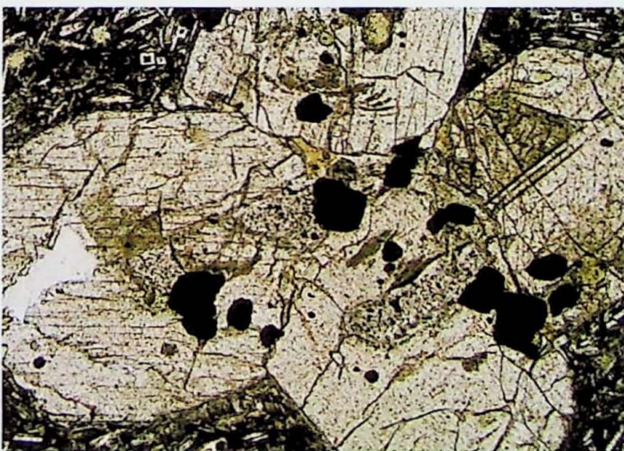
Fig. A5.11 - Fotomicrografia da amostra W-04 (derrame 4). Detalhe de cristais de piroxênio (Augita) com inclusões de minerais opacos (provavelmente ilmenita/magnetita). Nicóis paralelos. Objetiva: 10 X.
