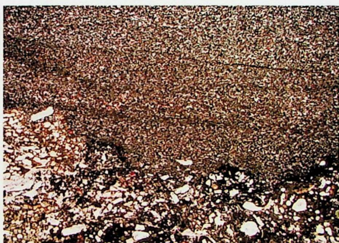
Fig. A5.21 - Fotomicrografia da amostra W-02 (Regolito (sedimento?) estratificado - derrame 6). Notar a seleção granulométrica da amostra. Nicóis paralelos. Objetiva: 1,25X.
