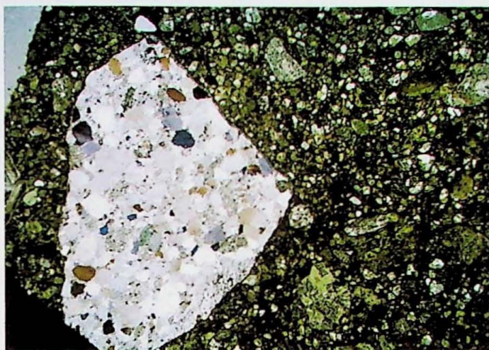
Fig. A5.25 - Fotomicrografia da amostra W-13 (Diamictito). Notar clasto de material quartzoso e como a amostra é mais mal selecionada em relação a amostra anterior (W-08). Nicóis cruzados. Objetiva: 1,25X.
