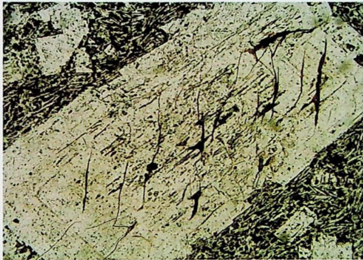
Fig. A5.3 - Fotomicrografia da amostra W-15 (derrame 1). Detalhe de fenocristais de plagioclásio (Andesina). Nicóis paralelos. Objetiva: 10X.
