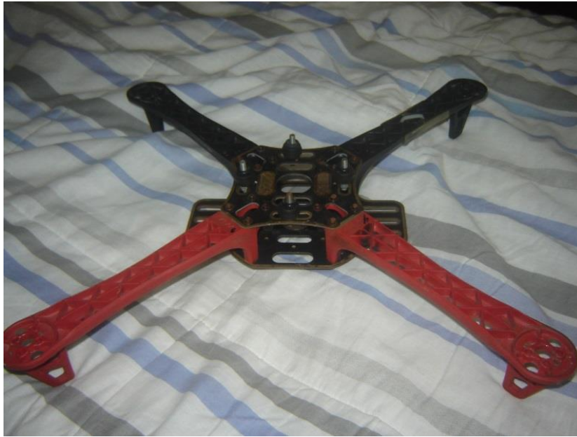
Figura 4 - Frame em ABS utilizado para montagem da aeronave. )
