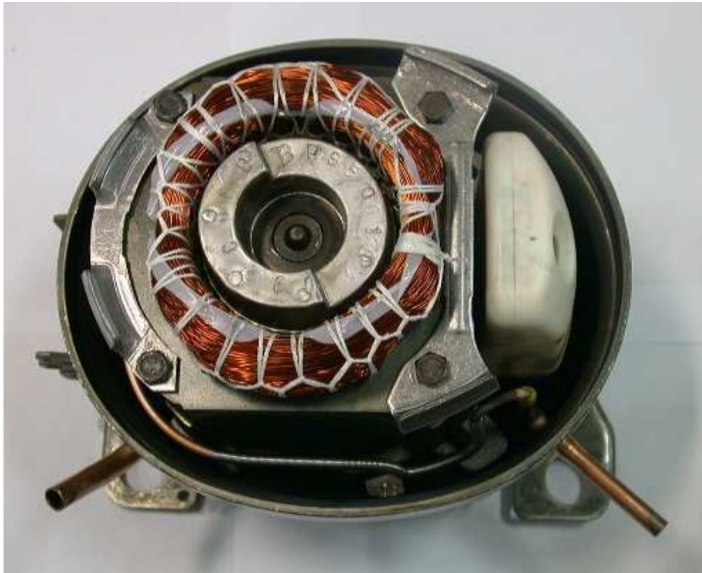
Figura 2-13 – Vista superior compressor hermético.
