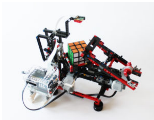
Figura 4 – Projeto em Mindstorms controlado por Raspberry Pie. Fonte: [4]
