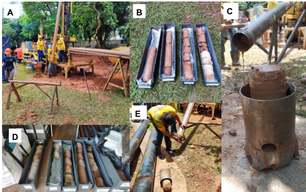
Figura 15: Etapas de coleta e armazenamento dos testemunhos da sondagem S1. A, C e E) Extração dos testemunhos do barrilete; B e D) Armazenamento dos testemunhos em caixas plásticas.
