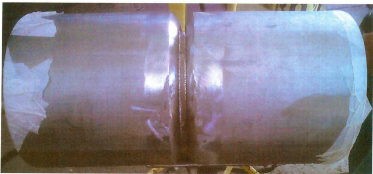
Figura 4.2 - Passe de raiz realizado pelo processo TIG
