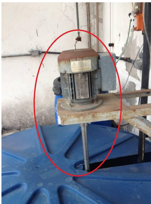
Figura 30 - Motor e haste sem proteção
