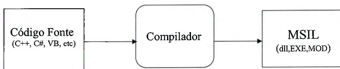
Fig. 3.1 Compilação na plataforma .NET, MSIL é produzido (Adaptado de(3)).
