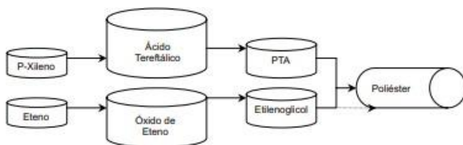
Figura 12. Rota 1 de produção de poliéster.
