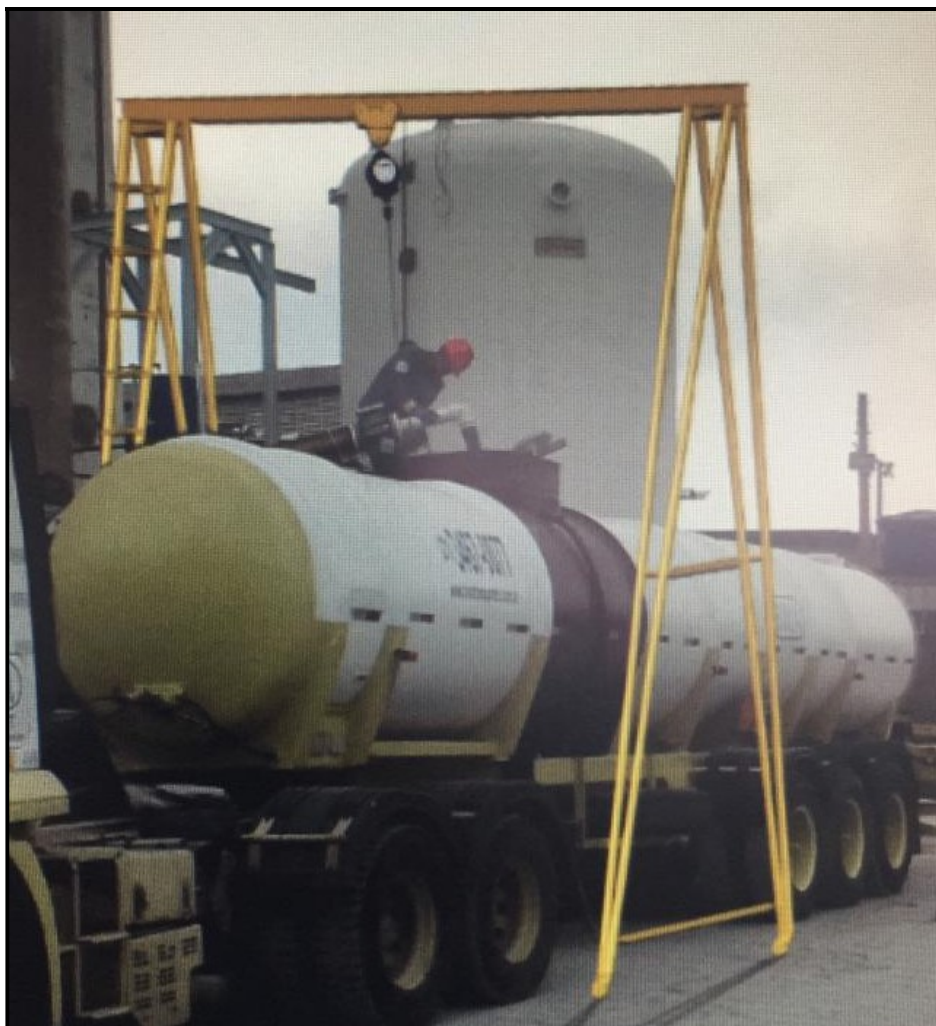
Figura 16 - Pórtico para Trabalho em Altura sobre Caminhão
