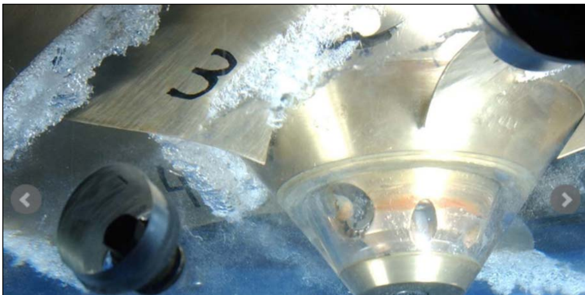
Figura 2.8 – Fenômeno de Cavitação em Turbina Kaplan: Fonte: www.epfl.ch
