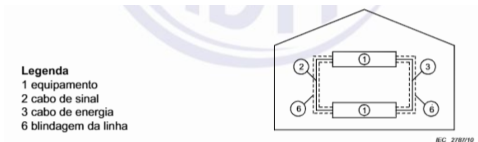
Figura 84 – Redução da influência do campo eletromagnético nas linhas por meio de blindagem
