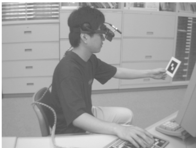
Figura 2.5: ARToolKit: calibração do HMD por meio do marcador de referência
