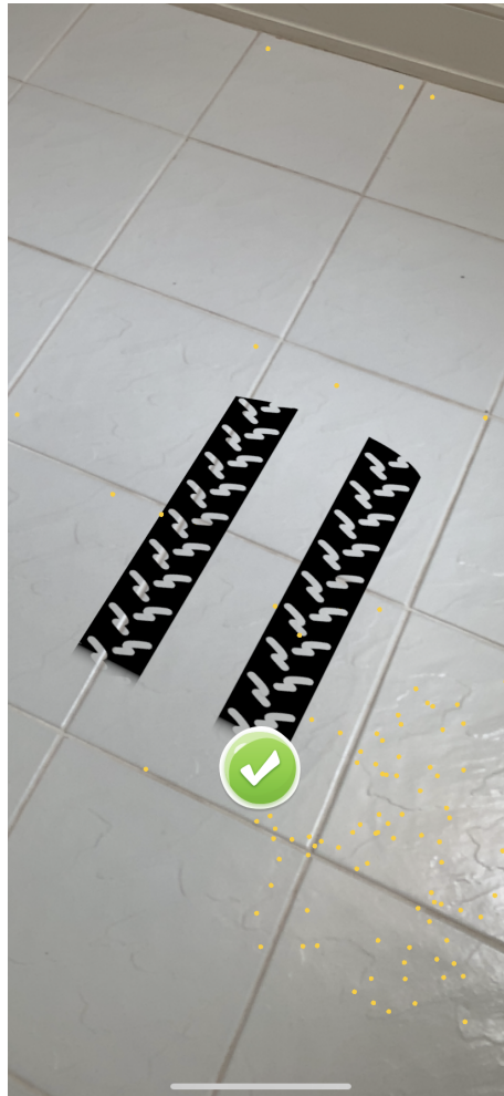
Figura 4.4: Etapa 1. Animação de marcas de pneu apontam superfície plana detectada. Feature points em amarelo
