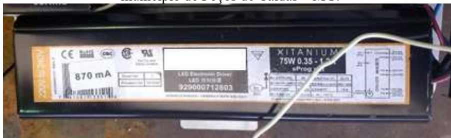
Figura 5 – Driver de Luminária LED com design que barra acesso a componentes internos no município de Poços de Caldas – MG.
