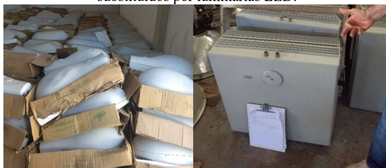
Figura 6 – Equipamentos de iluminação funcionais retirados da Iluminação Pública para serem substituídos por luminárias LED.
