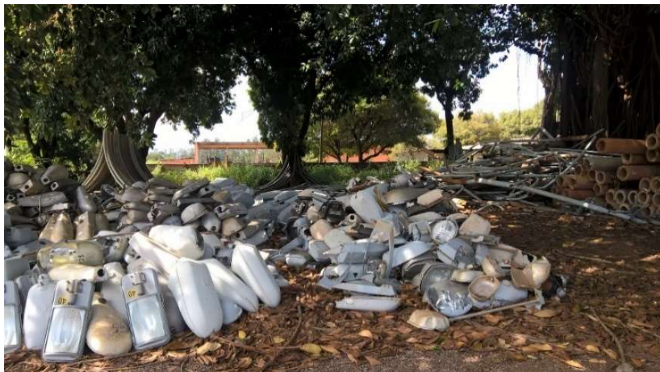
Figura 9 – Local de armazenamento do corpo de luminárias antigas em Brasília, em contato com vegetação, agentes climáticos e solo permeável.
