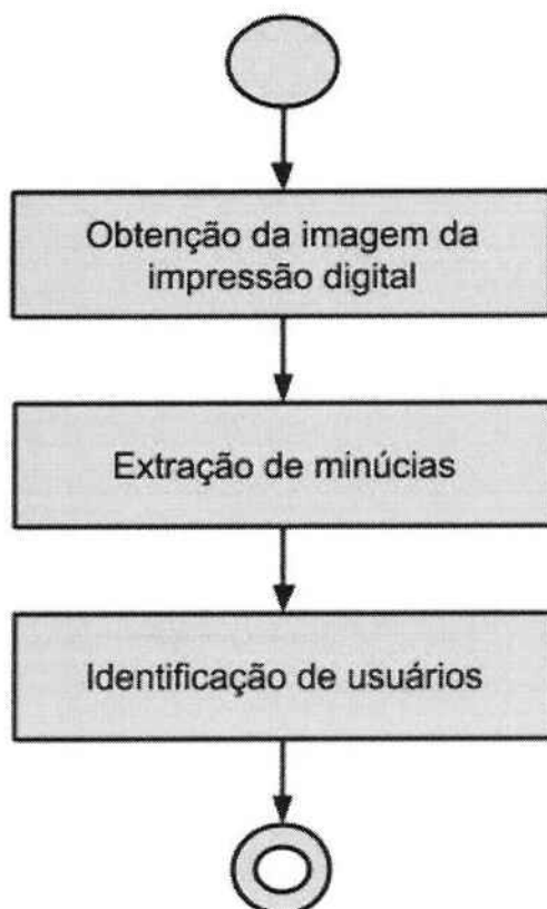
Figura 15 - Fluxo de execução do Sub-sistema 1
