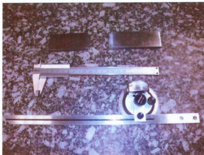
Figura 4.5 – Bloco padrão, paquímetro e goniômetro utilizados nas medições.
