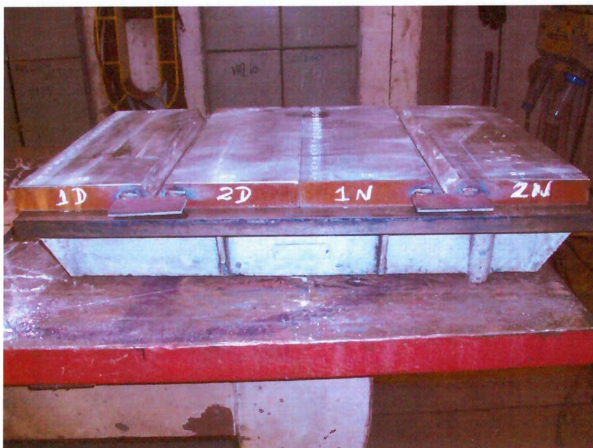
Figura 4.4 – Marcação na lateral das chapas para fazer as medidas de distorção.
