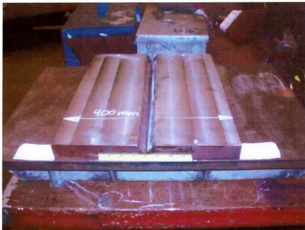
Figura 4.6 – Corpo de prova apoiado sobre a mesa de desempenho.
