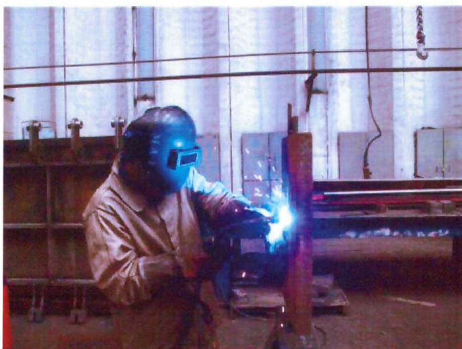
Figura 4.2 – Soldagem da raiz com a técnica convencional.
