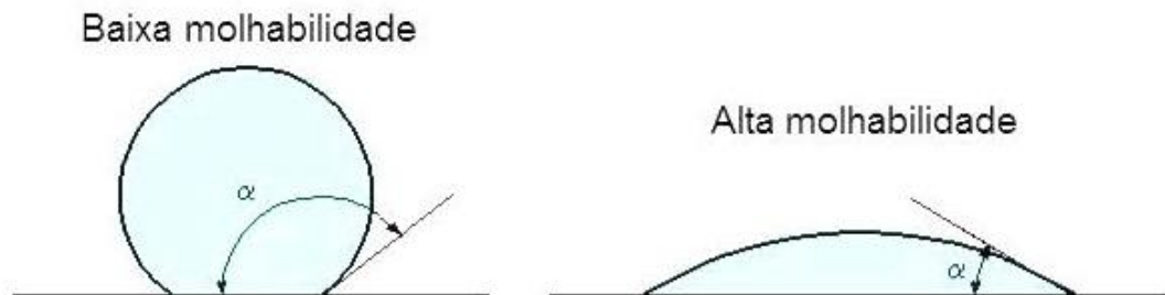
Figura 6 – Comparação entre o ângulo de contato e a molhabilidade.
