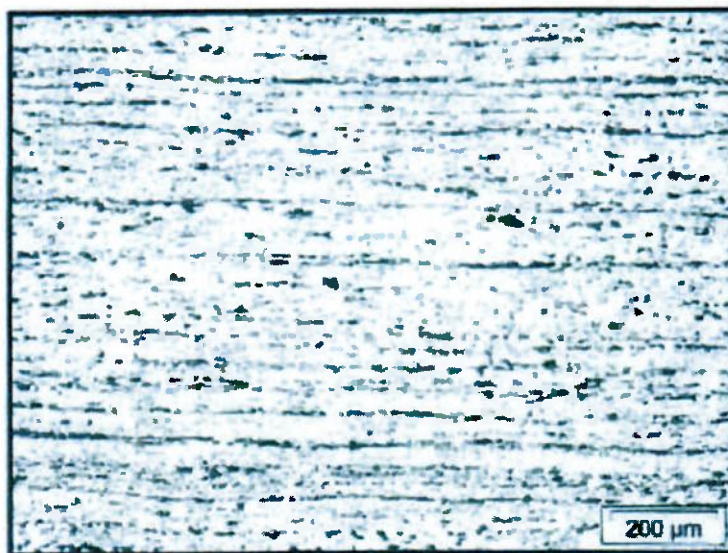
Figura 6.3.1.3 - Micrografia 100X do metal base da junta do tubo API 5L X70 PSL 2 de 24", ataque de nital a 2%.
