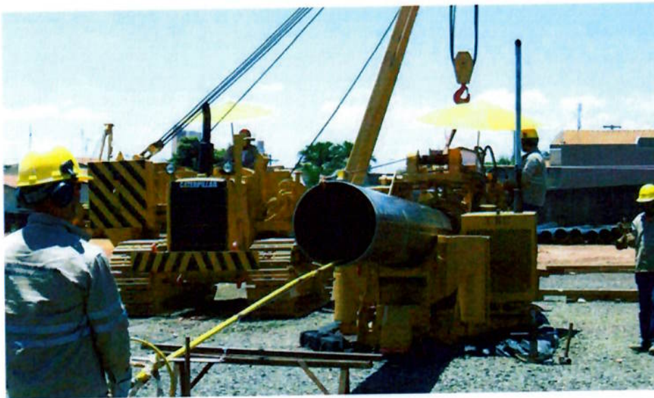
Figura 5.2.1 A - Vista de máquina de curvamento a frio com comando hidráulico
