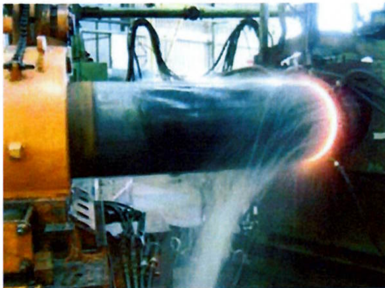
Figura 5.1.1 B - Vista da máquina de curvamento por indução da Protubo [21]
