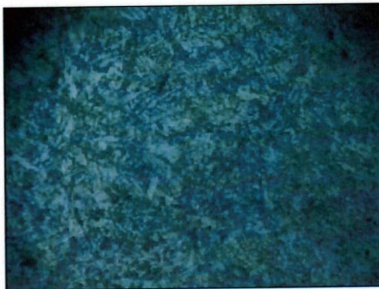
Figura 6.3.1.2 - Micrografia 200X na ZAC da junta do tubo API 5L X70 PSL 2 de 28". Ataque nital a 2%.
