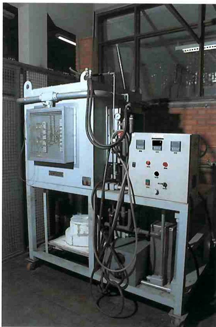
Figura 7: foto do forno tipo poço utilizado para as realizações dos experimentos.
