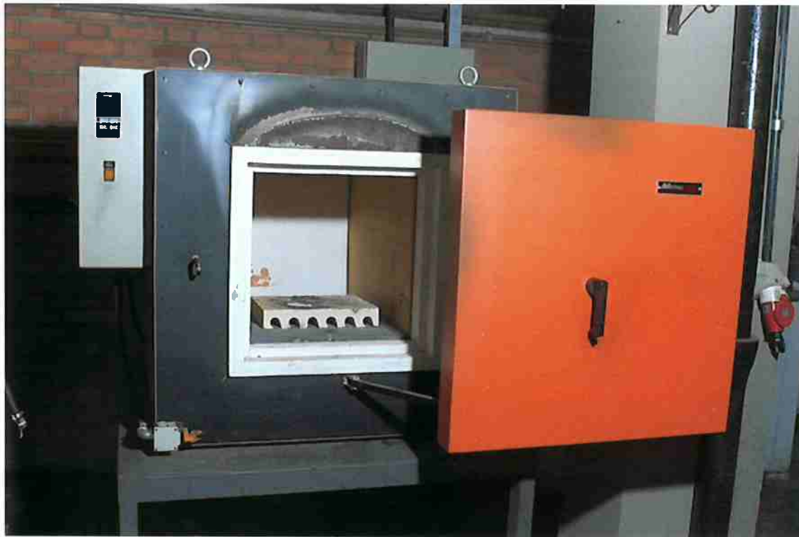
Figura 8: foto do forno tipo mufla utilizado para a realização da fusão e acerto de composição da liga utilizada neste estudo.
