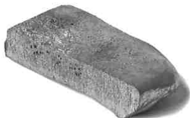
Figura 5: Foto da liga-mãe utilizada no experimento (Al-20%Si)
