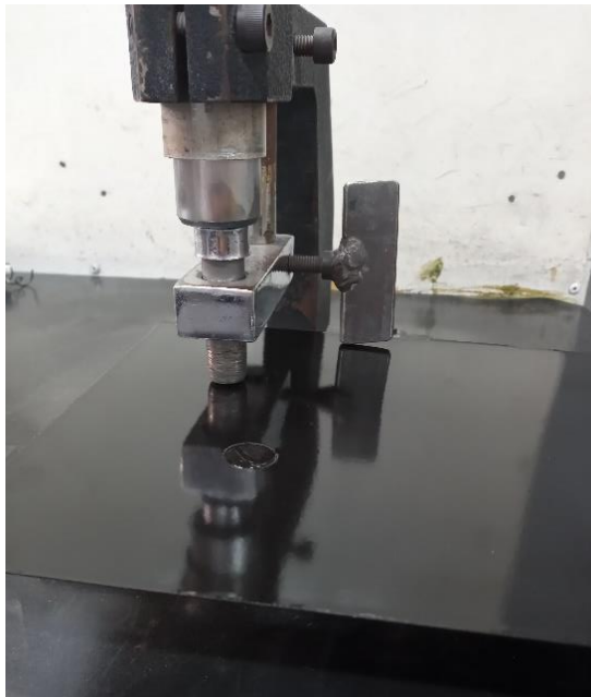
Figura 21 – Disposição do equipamento e da amostra para o teste de aderência
