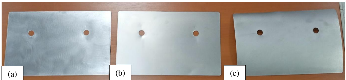
Figura 23 - Amostras preparadas para a aplicação do esmalte, (a) lixada, (b) sem tratamento e (c) jateada
