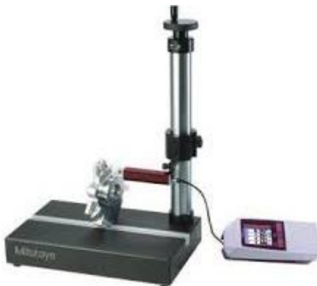
Figura 18 - Rugosímetro digital de bancada SURFTEST SJ-210 da marca Mitutoyo
