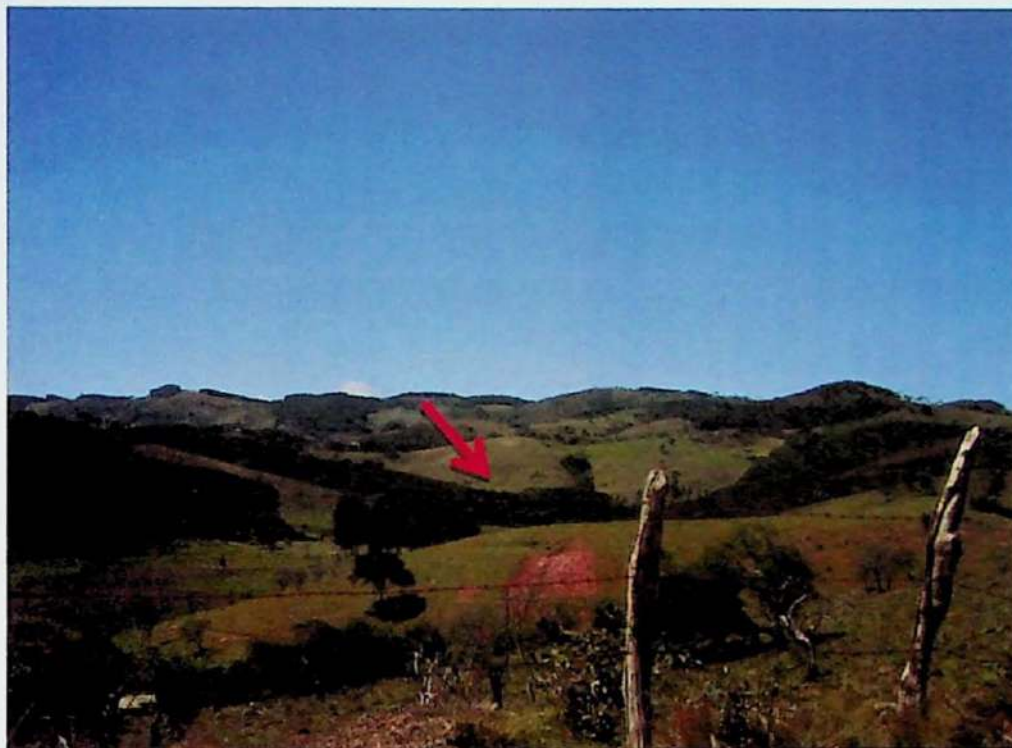
Foto 10 – Escorregamento em encosta natural induzido pelo pisoteamento do gado, visada para SE (Ponto TF-12-44).
