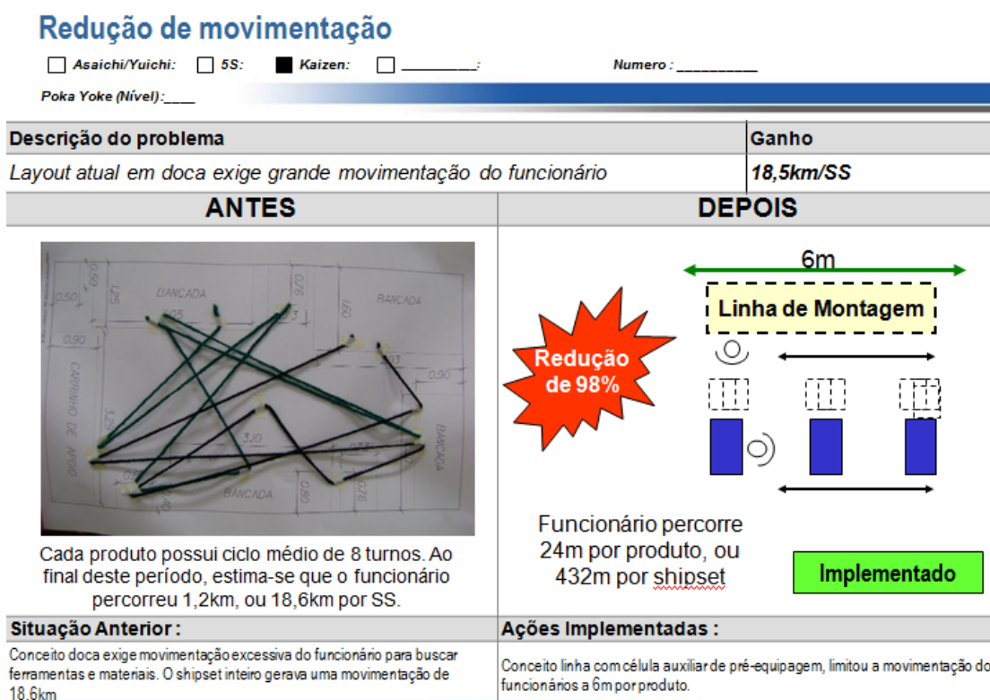
Figura 17 - Mudança no layout da área (redução de ciclo e de movimentação do operador)
