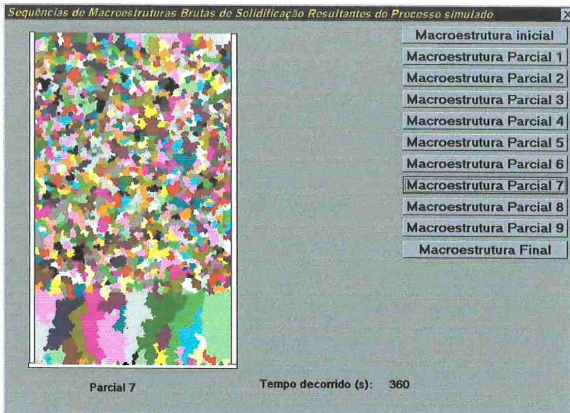
Figura 21k: Macroestrutura simulada para a experiência 2 em t=240s
