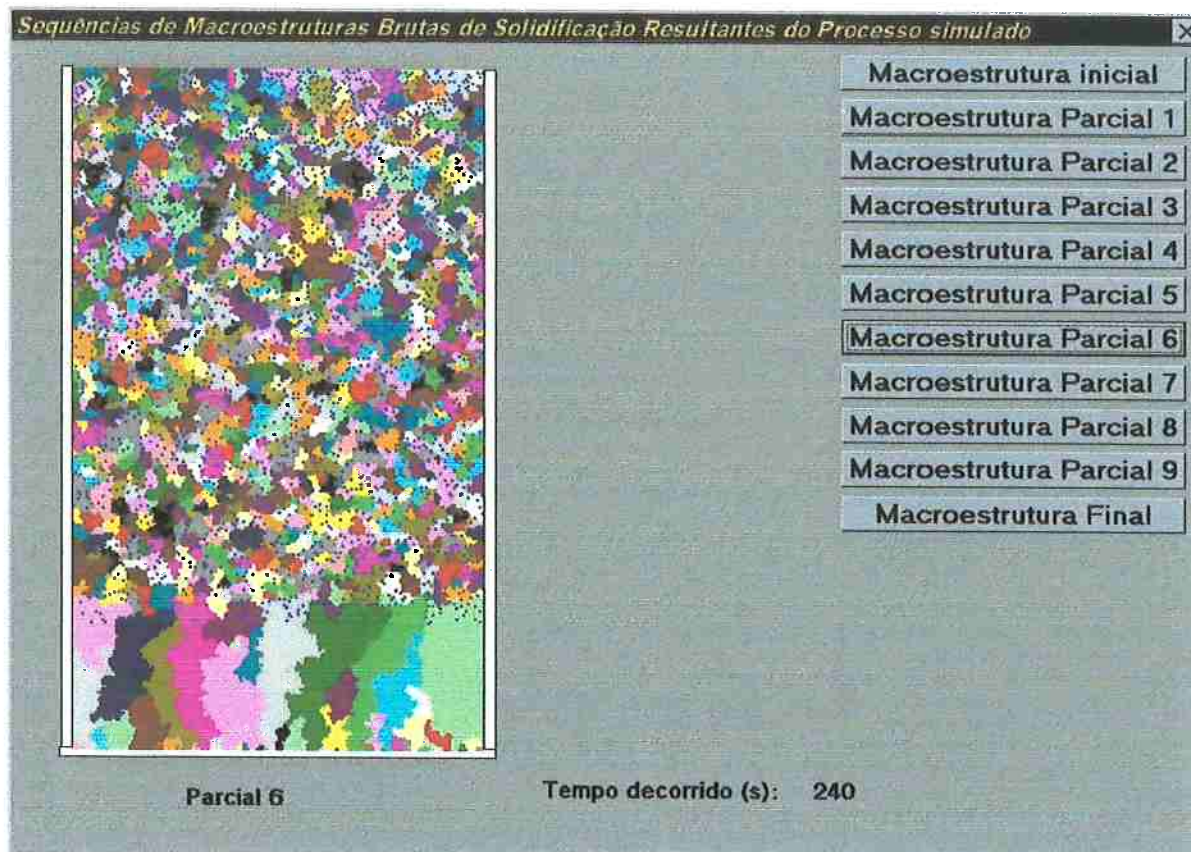
Figura 21i: Macroestrutura simulada para a experiência 2 em t=240s
