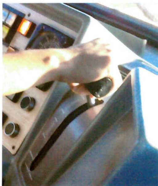
Figura 8 - Força exercida pelo piloto na alavanca para que o sistema não aplique "homem morto".
