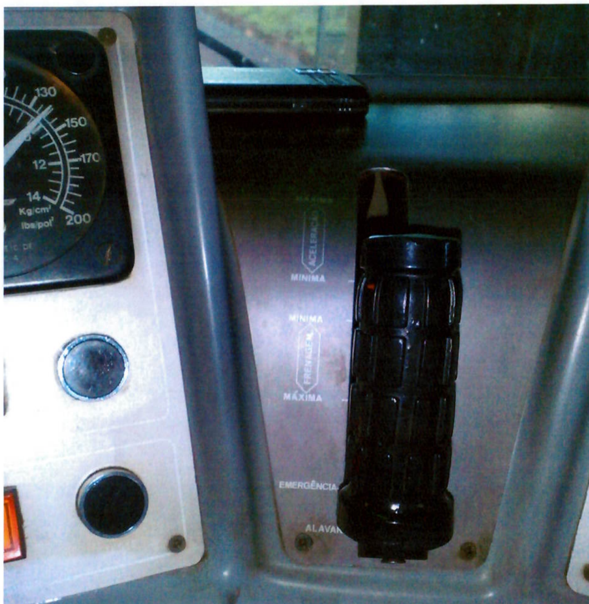
Figura 5 - Alavanca Master Control em posição inicial em cabine de um trem do Metrô - DF.
