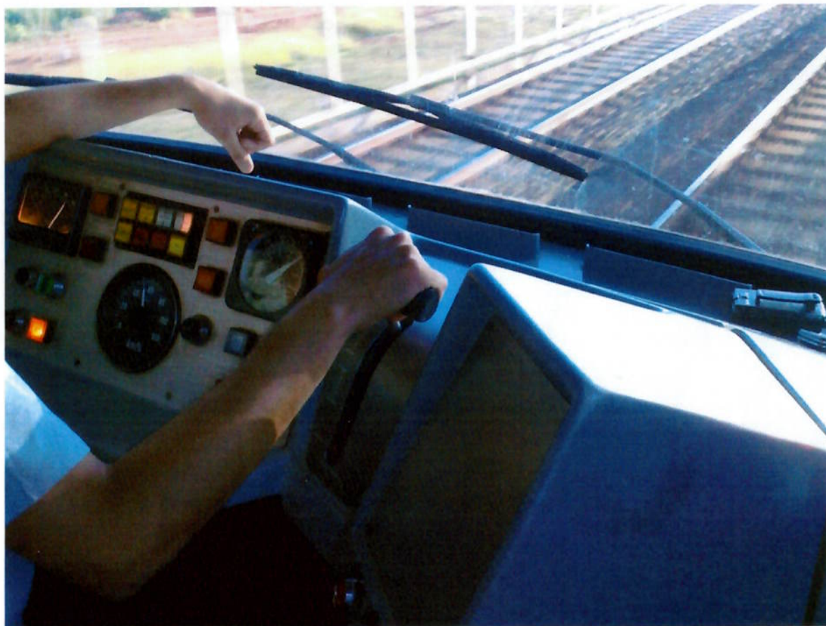
Figura 6 - Alavanca em posição de aceleração, após o giro horário de 90 graus.
