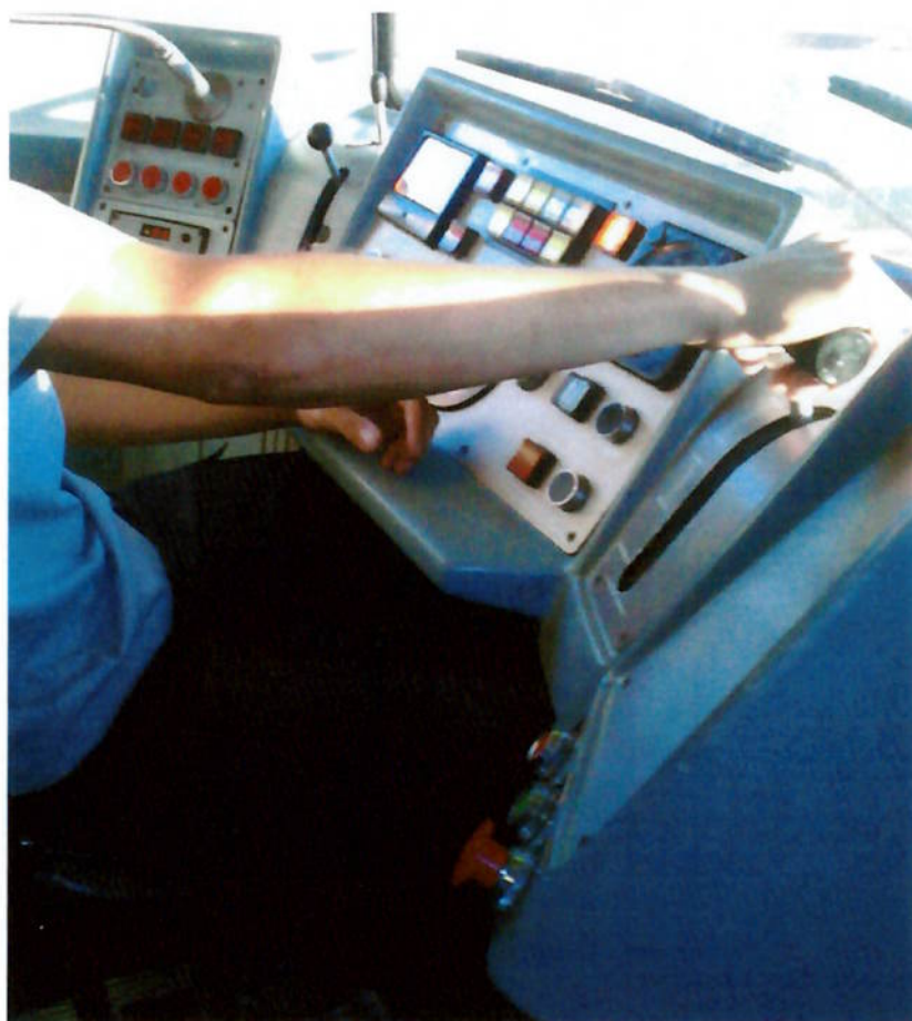
Figura 7 - Mostra o tamanho da alavanca e o braço do piloto suspenso e sem apoio.
